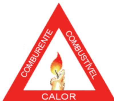
**Figura 1** – Triângulo do fogo ( Fonte: <http://www.areaseg.com/fogo/>)
