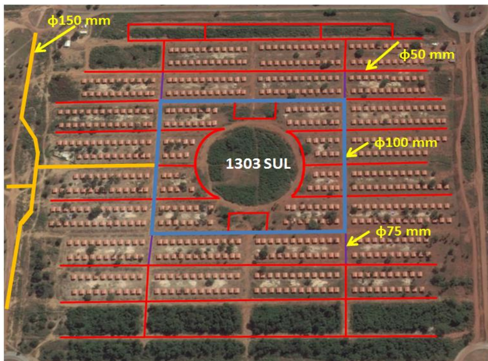
Figura 07: Layout da rede de distribuição existente na quadra 1303 sul.(Extraída do Google Earth e adaptada pela autora)
