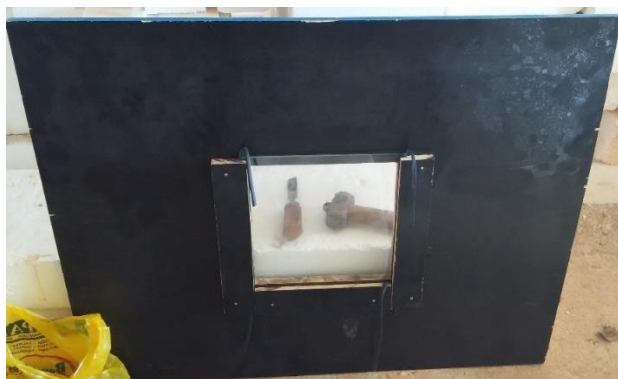
Figura 8 - Tiras de madeira em volta da janela
