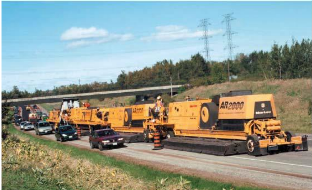
Figura 16: Pré-aquecedores utilizados na reciclagem “ in situ ” a quente
