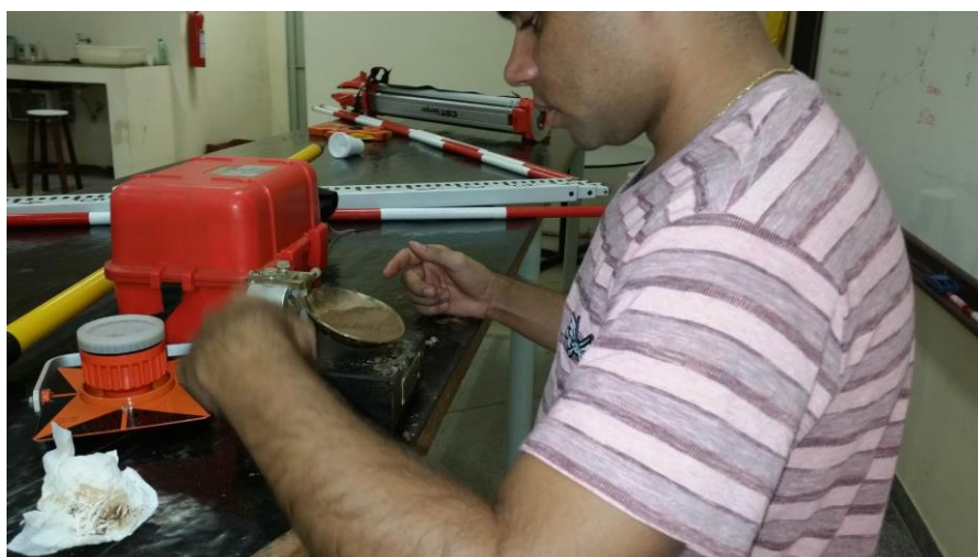
Imagem 4: Ensaio de limite de liquidez
