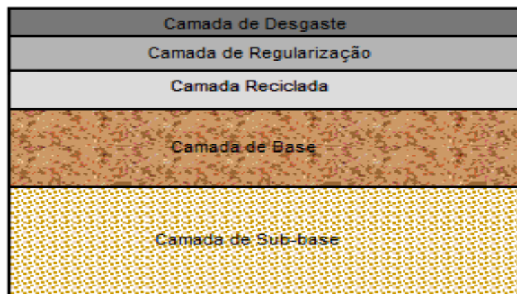
Figura 8: Estrutura de um pavimento reciclado “ in situ ” a frio com cimento
