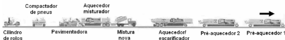
Figura 15: Fases da reciclagem a quente “ in situ ”
