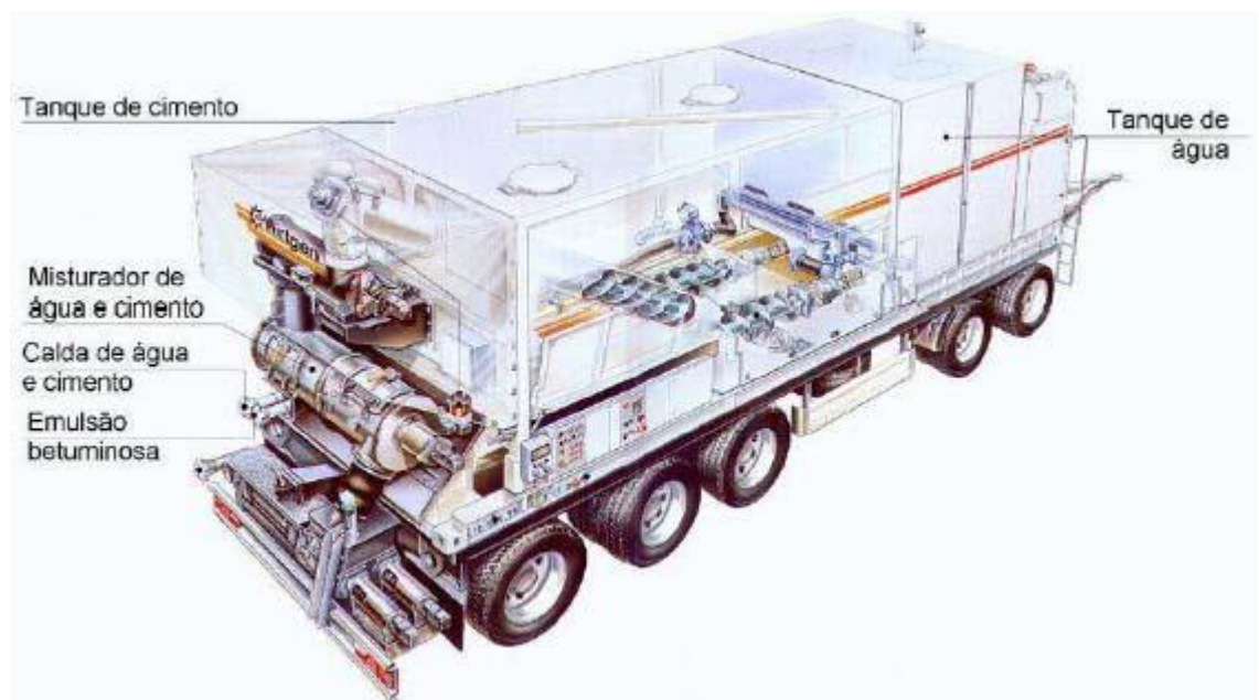
Figura 10: Esquema de uma misturadora
