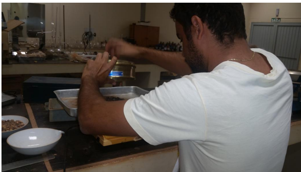
Imagem 3: Pesagem do material retido em cada peneira
