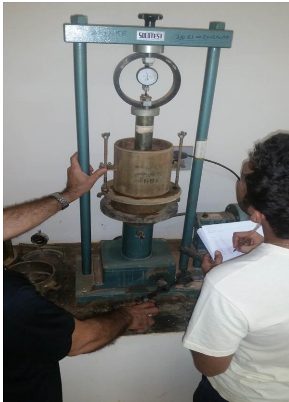
Imagem 2: Leitura das deformações do solo
