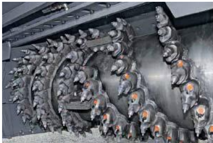
Figura 7: Rotor de uma máquina recicladora
