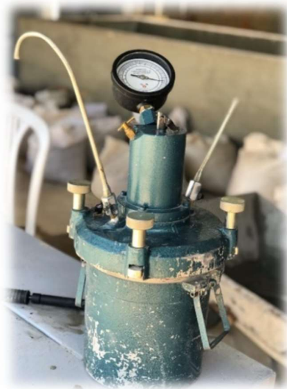
Figura 22 - Ensaios de teor de ar em concreto fresco.
