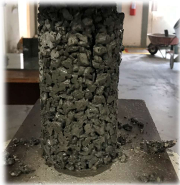
Figura 33- CP's com ruptura cisalhada lateral
