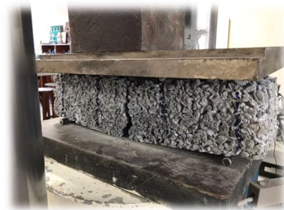
Figura 29 – Ensaio de tração na flexão (Ruptura dentro do terço médio)
