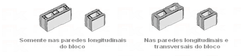
Figura 6 - Argamassa de assentamento.
