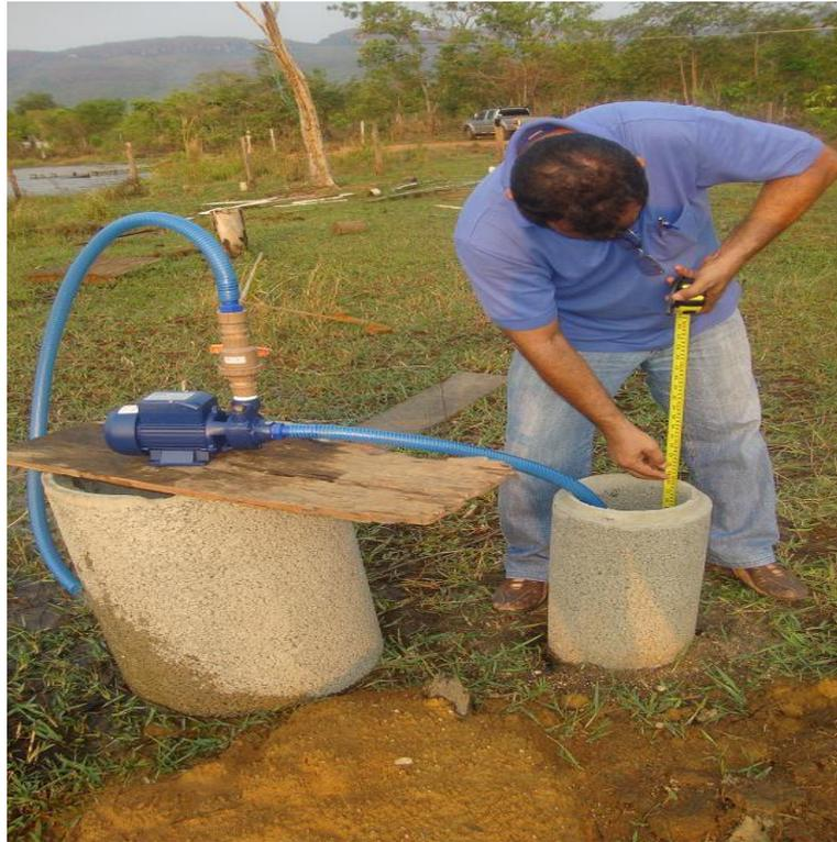
Figura 16. Medição da vazão do poço amazonas
