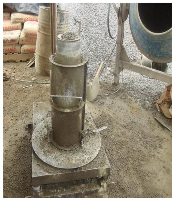
Figura 5. Fôrma metálica do tubo
