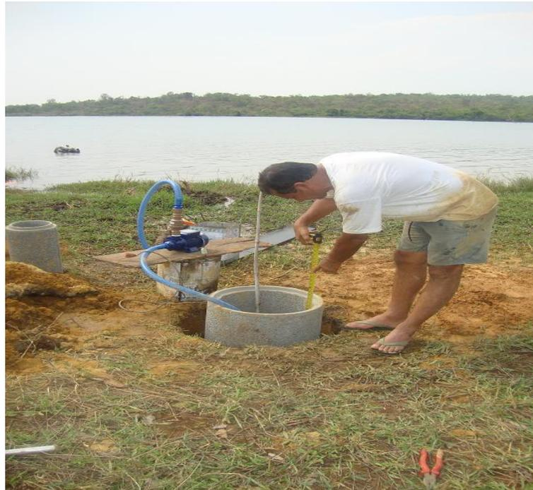
Figura 17. Medição da vazão do poço amazonas
