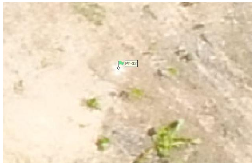
Figura 34 - Marcação manual dos pontos encontrados nas fotos (Pontos ajustados em relação a marcação em "x")
