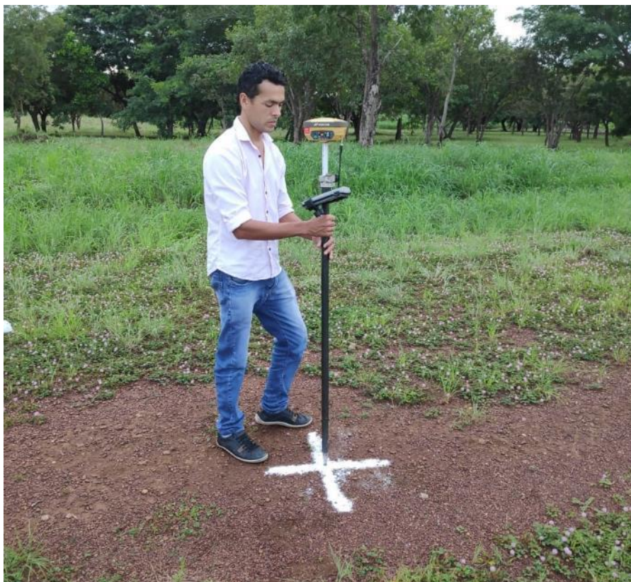
Figura 24 - Levantamento dos pontos de controle
