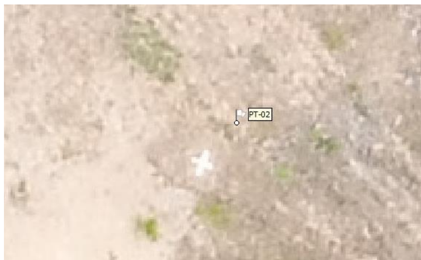
Figura 33 - Marcação manual dos pontos encontrados nas fotos (Ponto deslocado em relação a marcação em "X")
