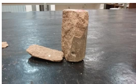
Figura 19 – Ruptura do corpo de prova com argamassa convencional
