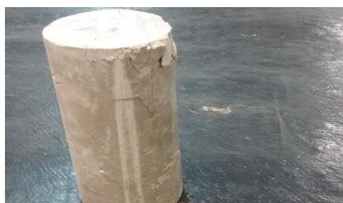
Figura 20 – Ruptura do corpo de prova com argamassa de vermiculita e EPS
