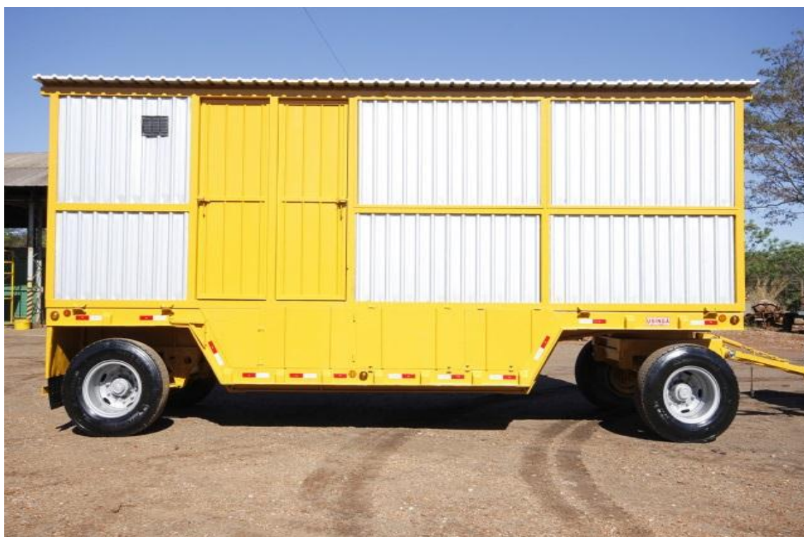
Figura 1. Contêiner usado de vestiário.
