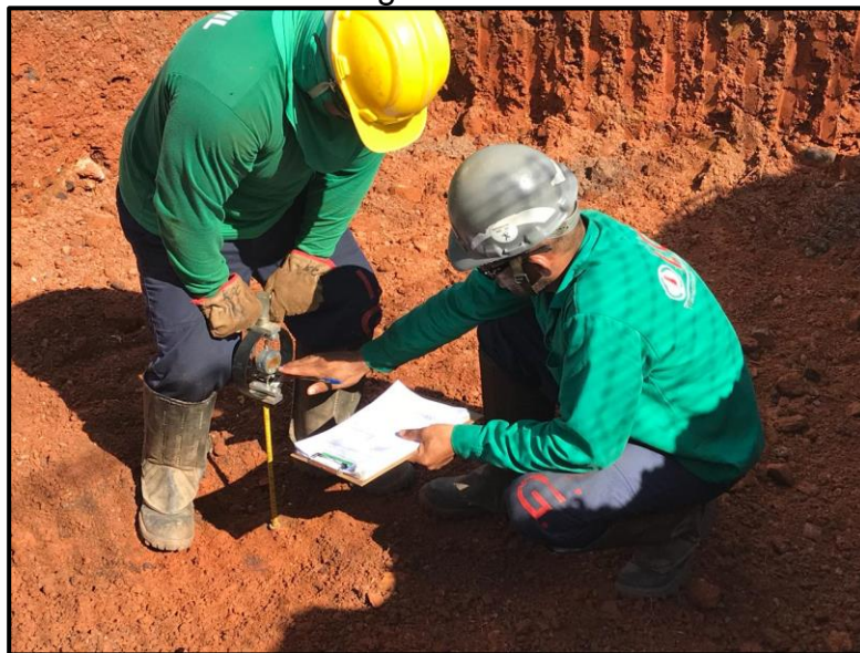
Figura - 39 - Ensaio com uso do penetrômetro para determinação da capacidade de carga do solo.
