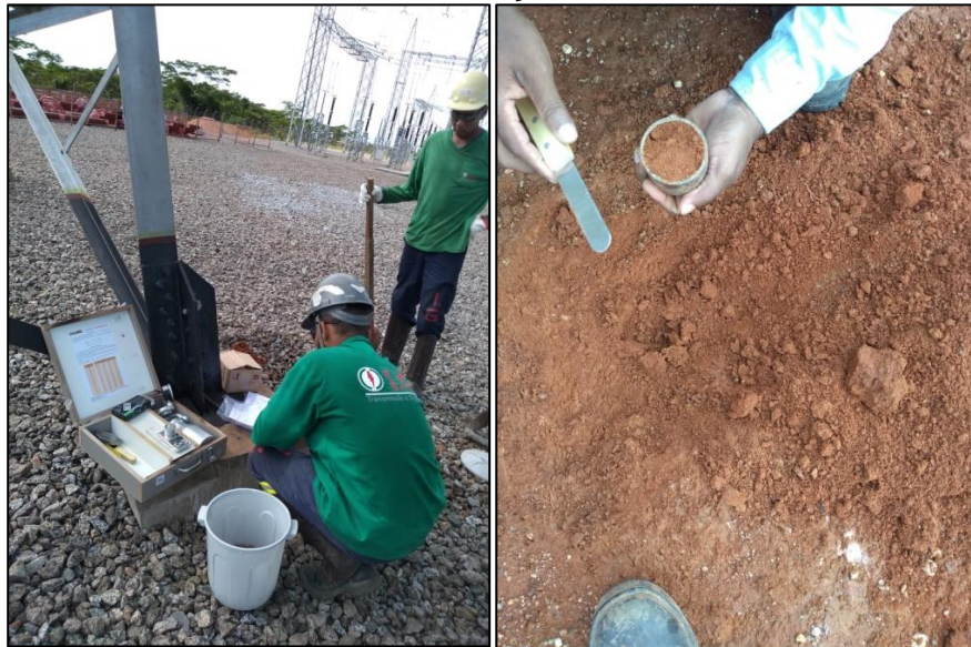
Figura - 43 - Ensaio do teor de umidade e compactação do solo com Speedy teste e método de cravação do cilindro
