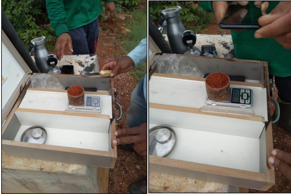
Figura - 44 - Ensaio com Speedy teste e cilindro de cravação.
