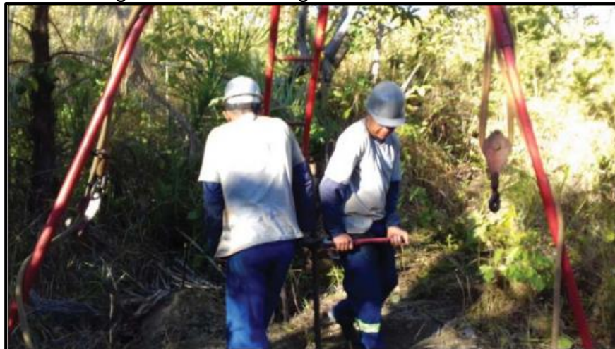
Figura - 22 - Sondagem a trado torre 33
