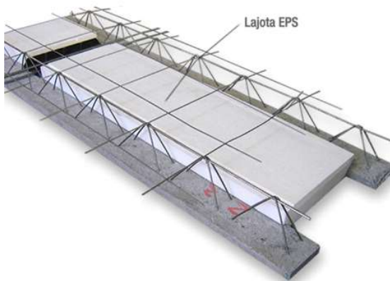
Figura37– Sistema de vigas treliçadas e EPS para vedação e suporte do concreto na laje
