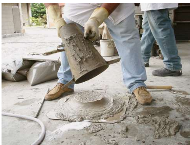
Figura 12 – Ensaio Slump Flow
