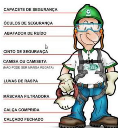
**Figura 7: Equipamentos de uso obrigatório em construções civis**
