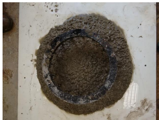
Figura 28: Ensaio de J-Ring
