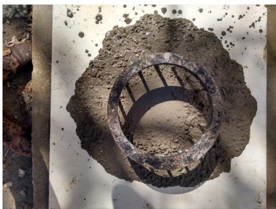
Figura 27: Ensaio de J-Ring
