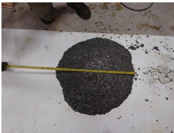
Figura 26: Ensaio Slump Flow Test
