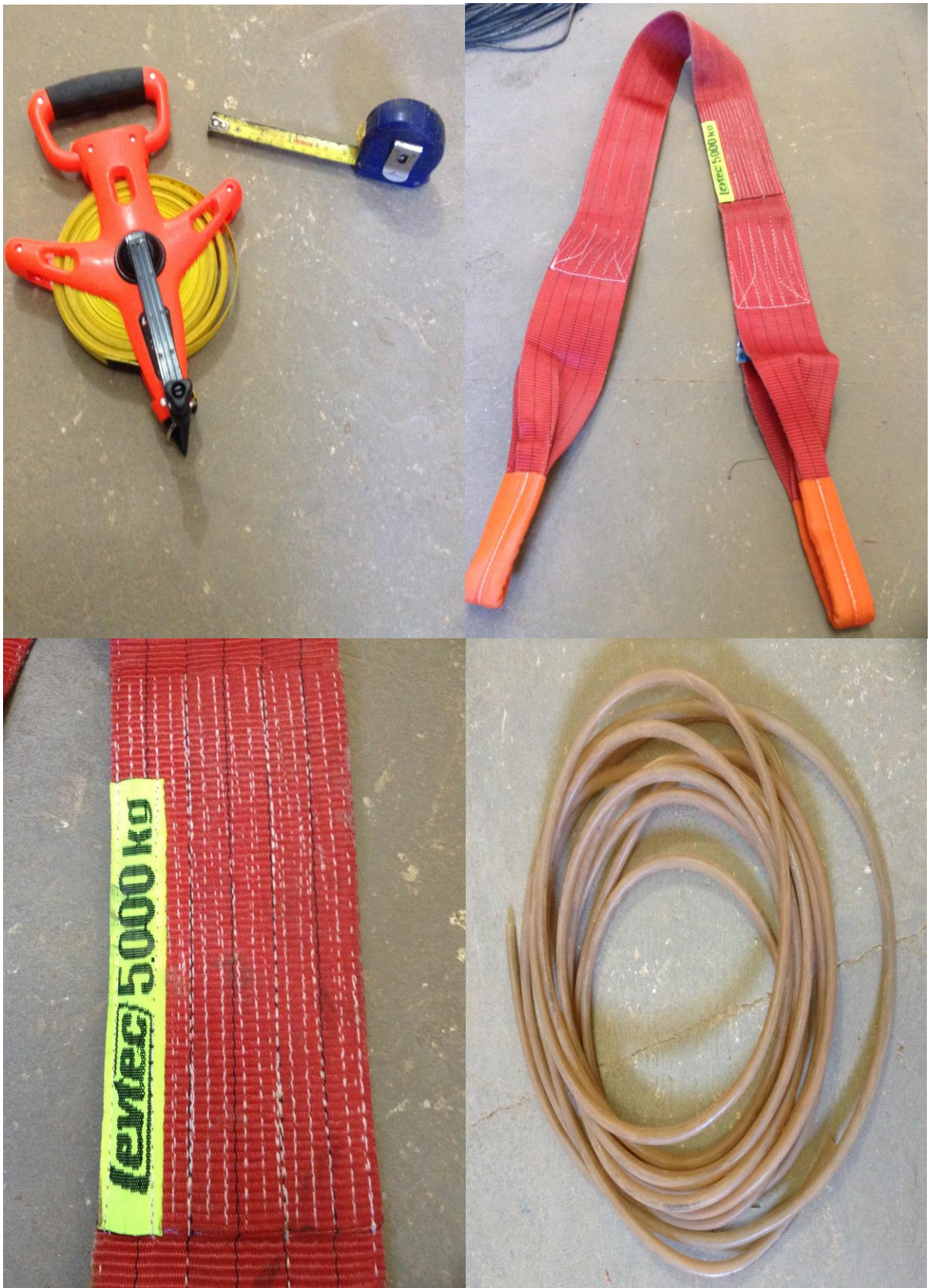
Figura 30: Ferramentas para medição (Trenas, cintas de içamento e mangueira de nível.)
