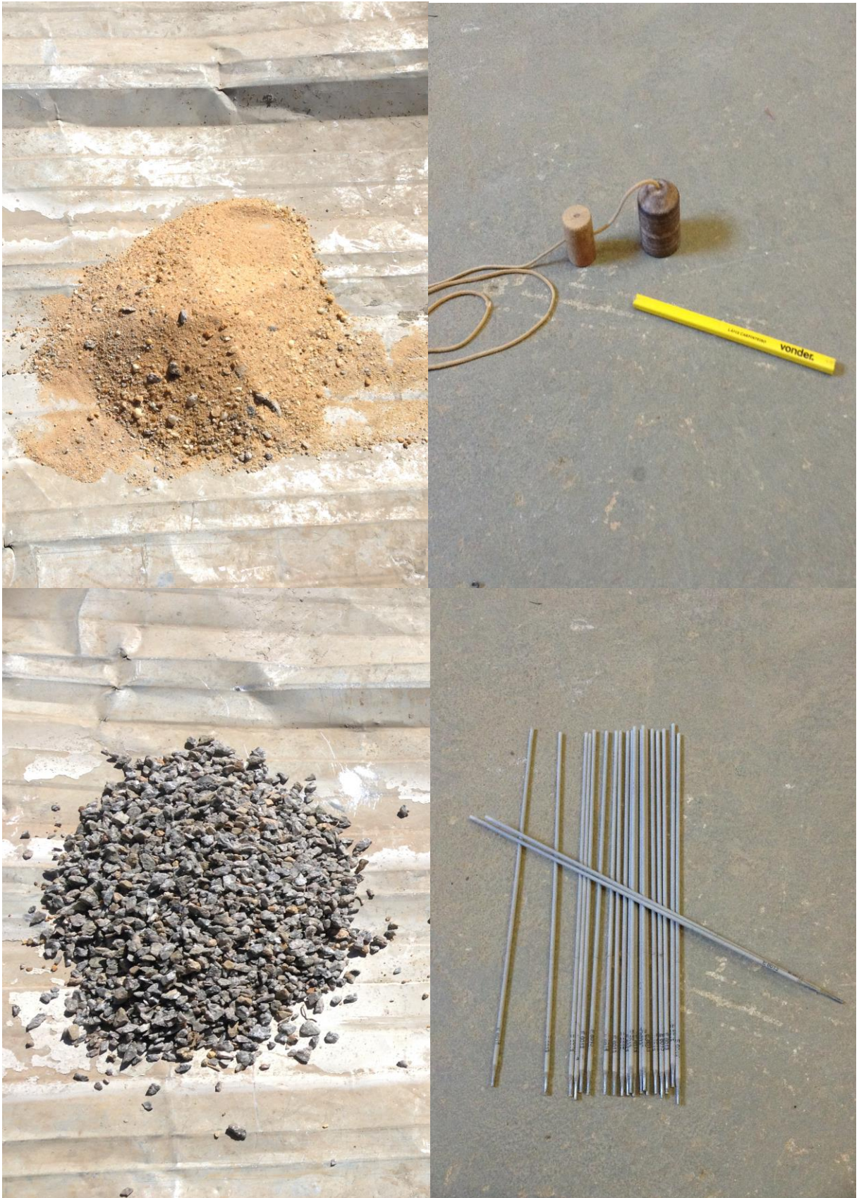
Figura 28: Areia, prumo de face, lápis, brita e eletrodo.
