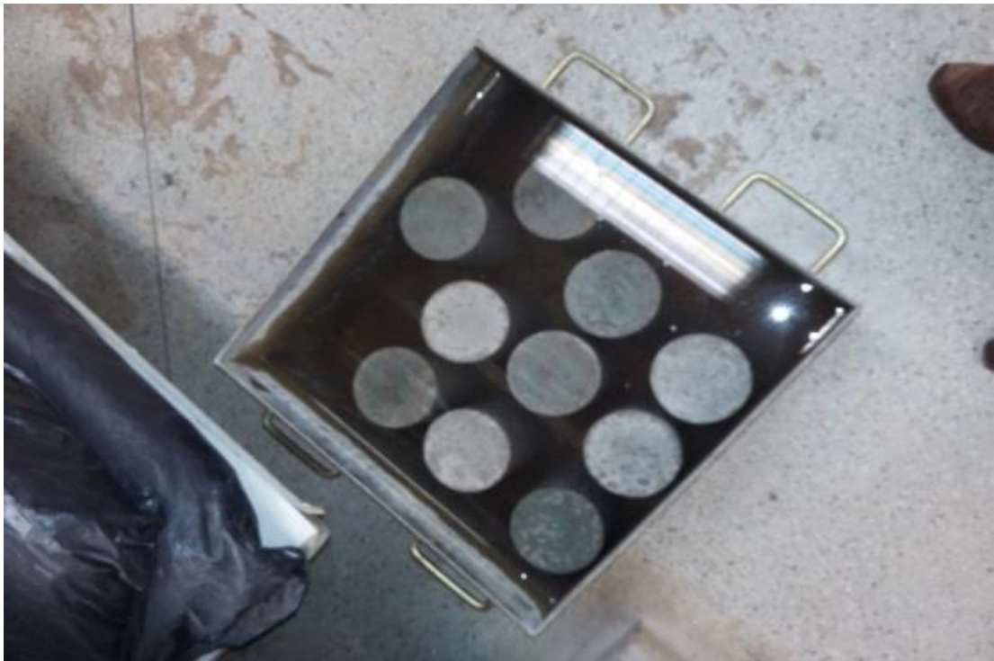
Figura 20 - Procedimento de ensaio de absorção por imersão.
