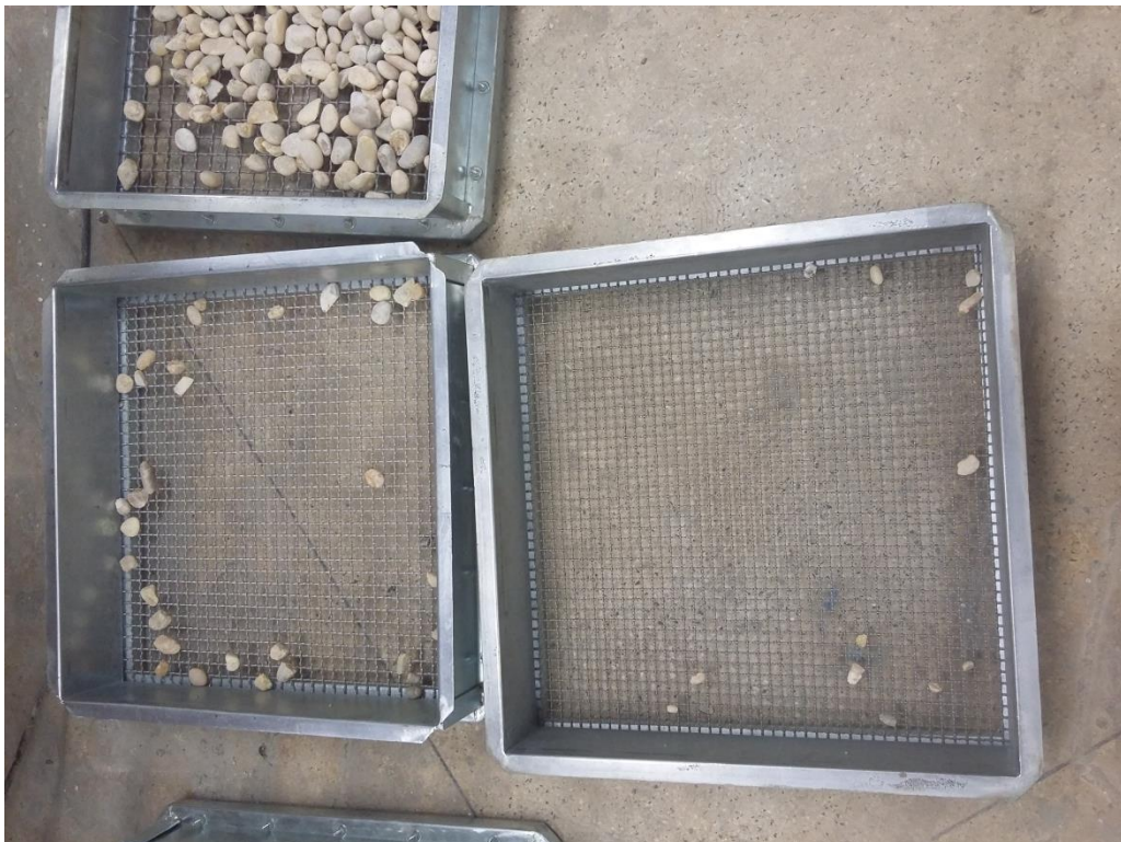
Figura 7 - Seixo rolado retido nas peneiras durante o ensaio de granulometria.
