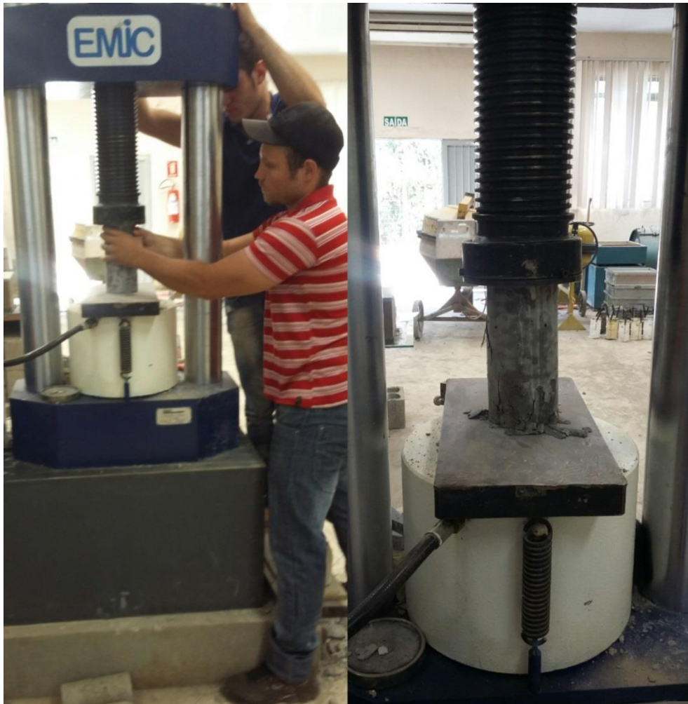
Figura 18 - Rompimento de corpos-de-prova do concreto em estudo.
