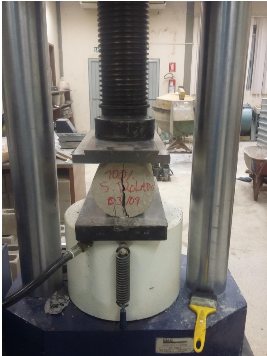
Figura 19 – Corpo-de-prova alinhado centralizando no dispositivo de compressão diametral.
