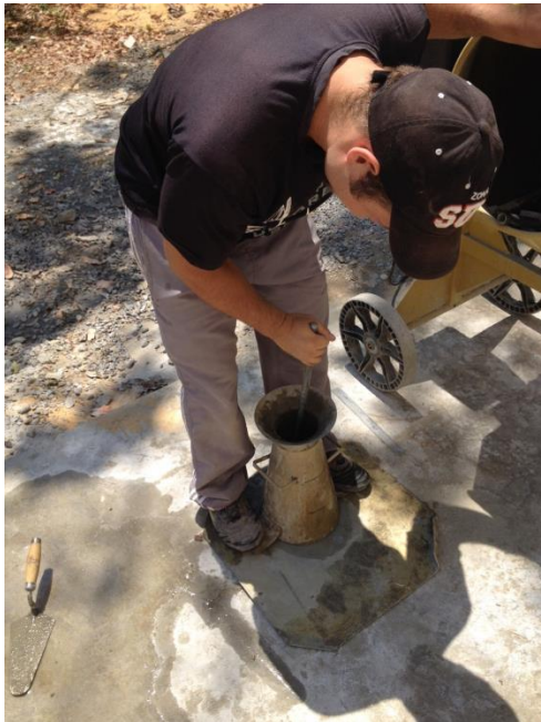
Figura 16 – Consumação do ensaio de abatimento de tronco de cone – a) Adensando a primeira camada com 25 golpes. b) Medindo a trabalhabilidade do concreto.
