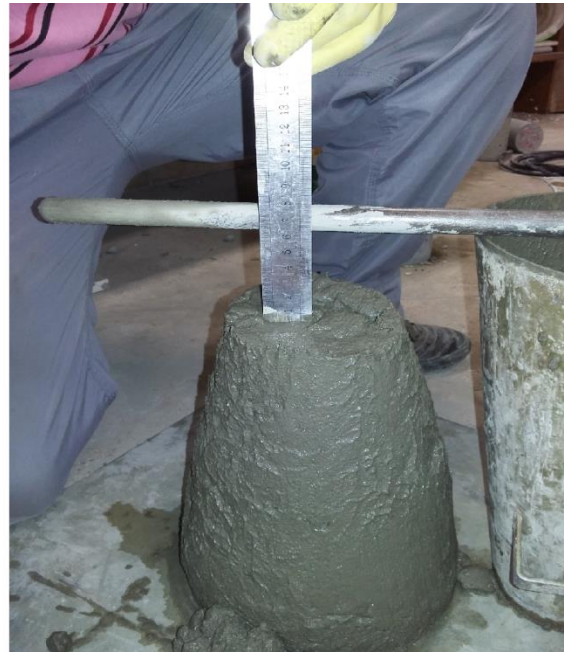
Figura 16 – Consumação do ensaio de abatimento de tronco de cone – a) Adensando a primeira camada com 25 golpes. b) Medindo a trabalhabilidade do concreto.
