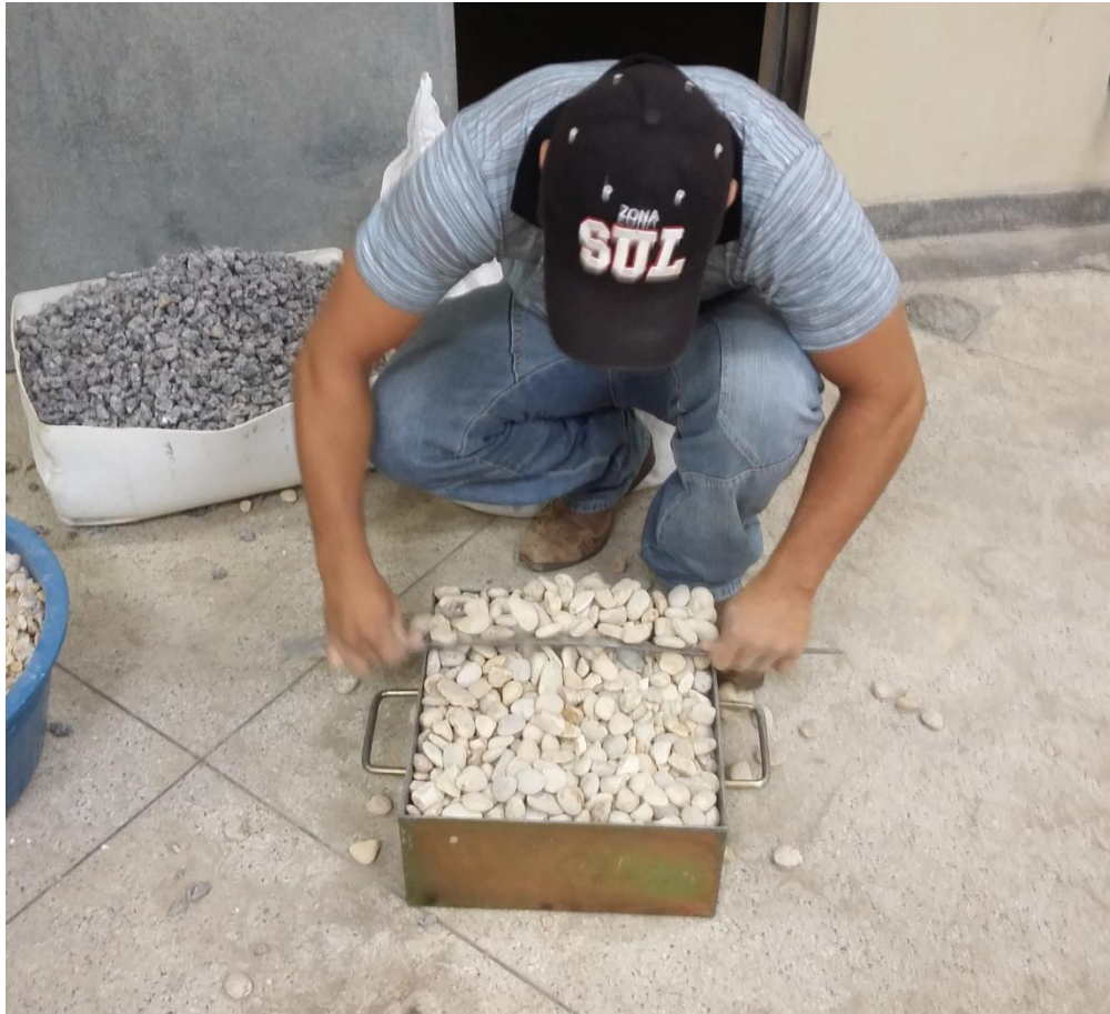
Figura 12 – Execução do ensaio de massa unitária do agregado graúdo.
