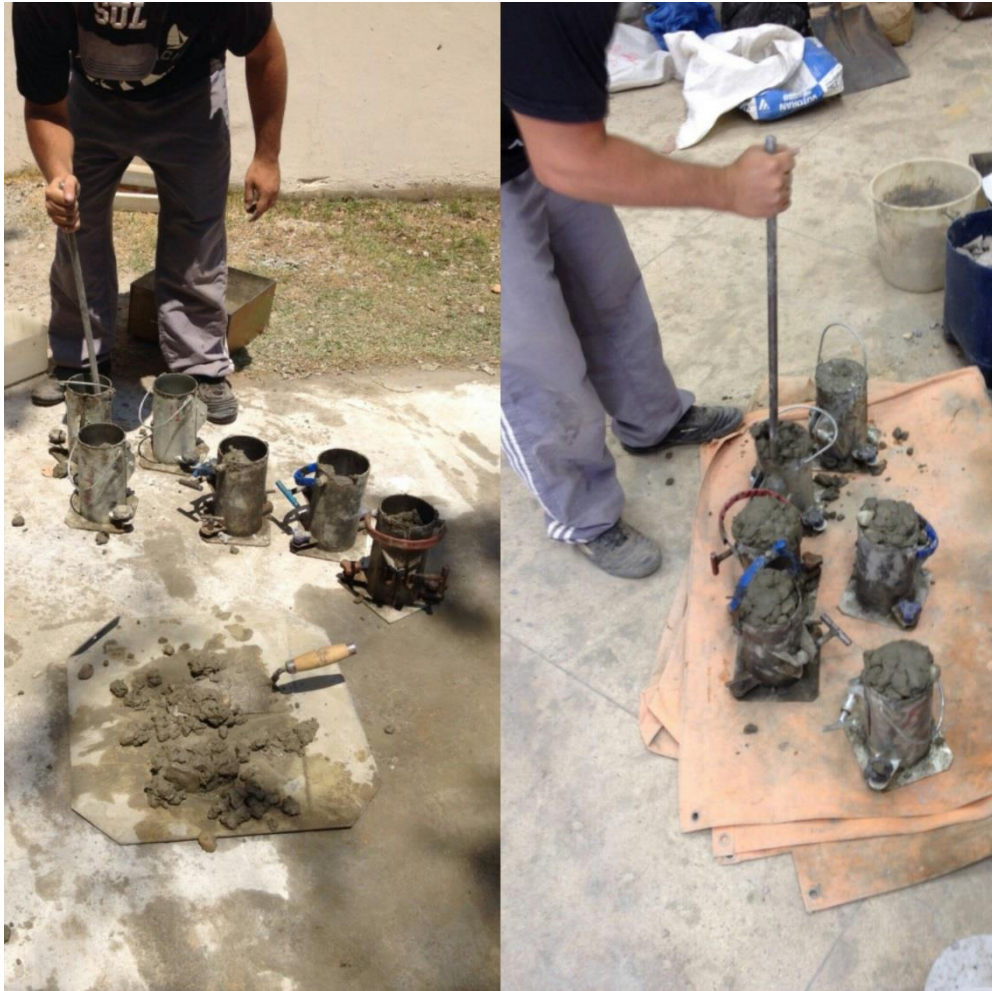
Figura 17 – Procedimento de execução dos corpos-de-prova.
