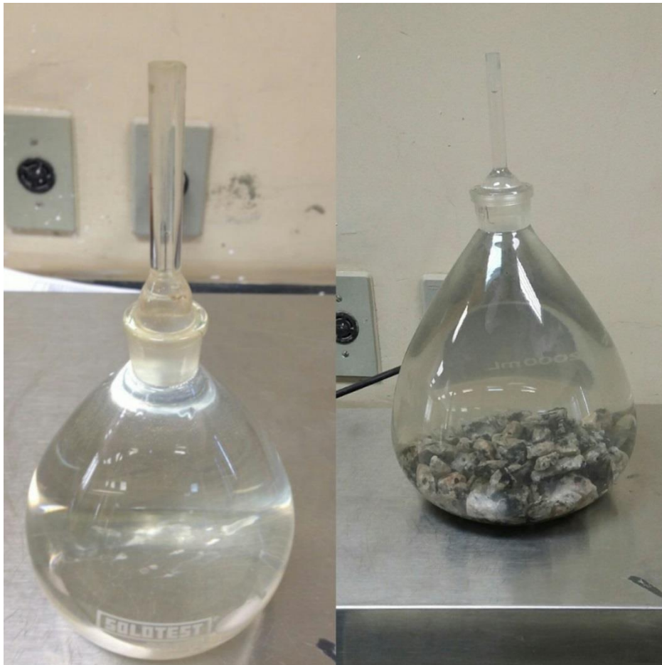
Figura 11 – Determinação da massa específica do agregado graúdo pelo método do Picnômetro.
