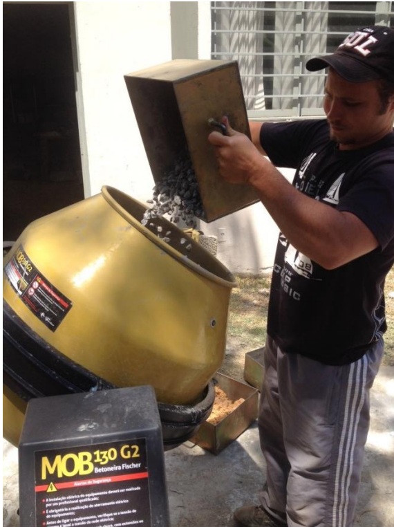
Figura 14 – Procedimento de lançamento do material na betoneira – a) Lançamento da brita granítica na betoneira. b) Lançamento da metade da água.
