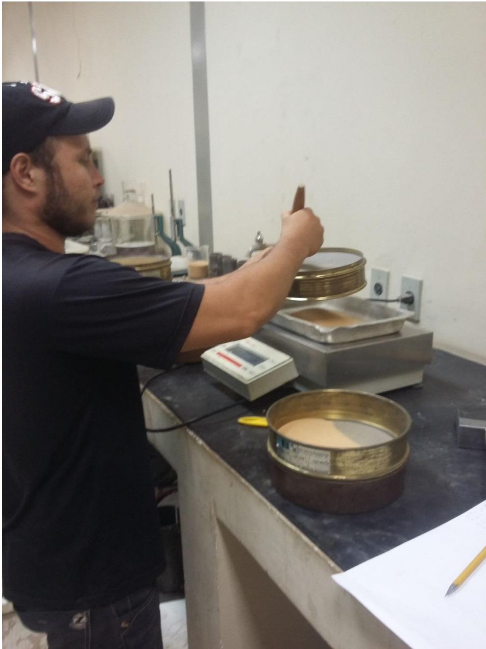
Figura 6 - Pesagem da areia retida nas peneiras.
