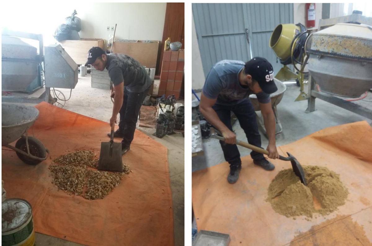
Figura 4 - Procedimento de quarteamento dos materiais empregados na pesquisa – a) Quarteamento do seixo britado. b) Quarteamento da areia.
