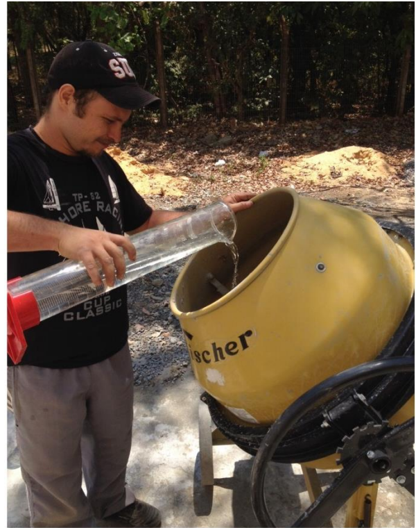
Figura 14 – Procedimento de lançamento do material na betoneira – a) Lançamento da brita granítica na betoneira. b) Lançamento da metade da água.
