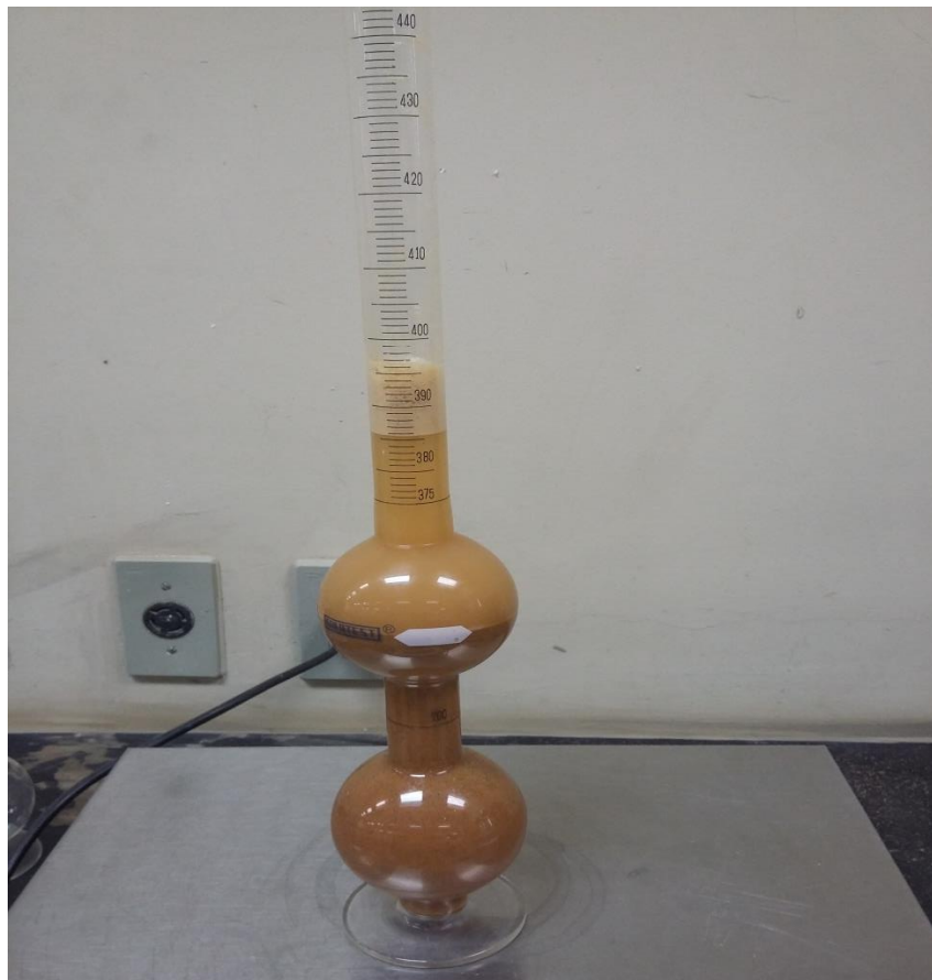
Figura 10 – Determinação da massa específica do agregado miúdo pelo frasco de Chapman.
