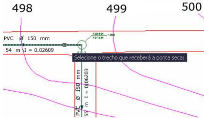
Figura 36. Visualização da tela pedindo seleção do trecho para inserir a ponta seca.
