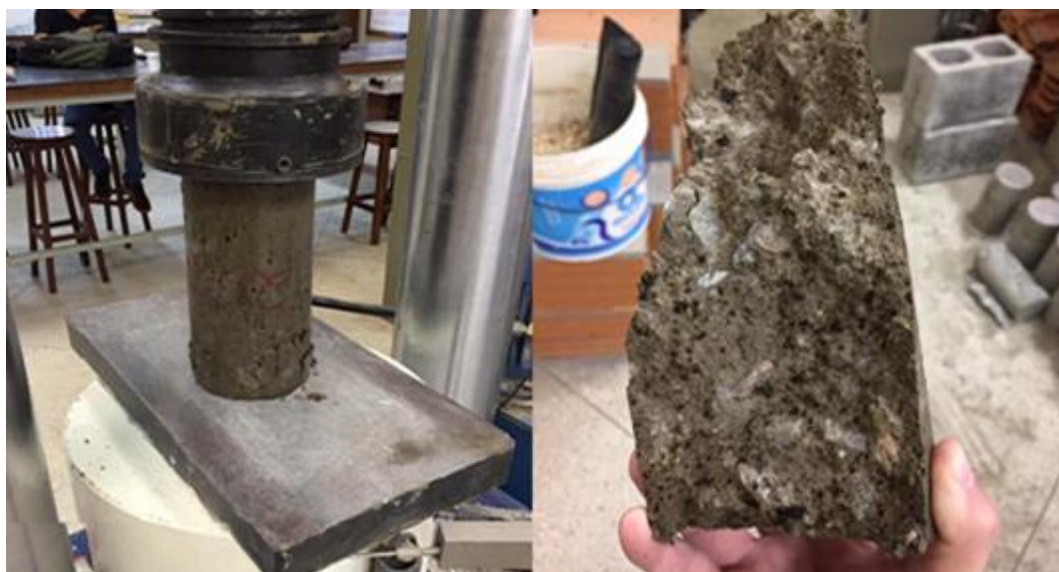
Figura 8 - Corpo de prova após ensaio de compressão axial.
