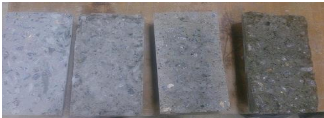
Figura 10 - Corpos de prova T0, T1, T2 e T3 após ensaio de tração por compressão diametral.
