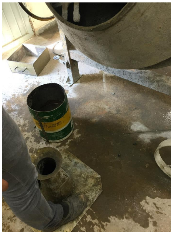
Figura 5 - Slump Test
