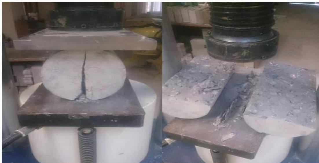
Figura 9 - Corpo de prova após ensaio de tração por compressão diametral.
