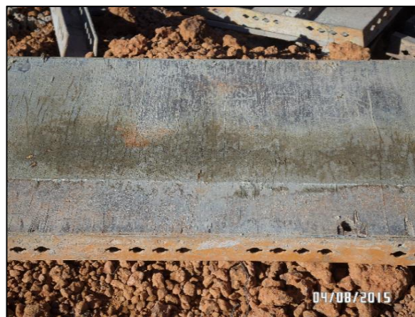
Figura 41 – Fôrma após sucessivas utilizações Fonte: Da autora (2015)
