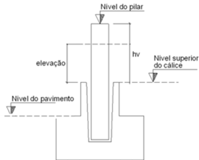
Figura 12 - Caracterização da sapata
