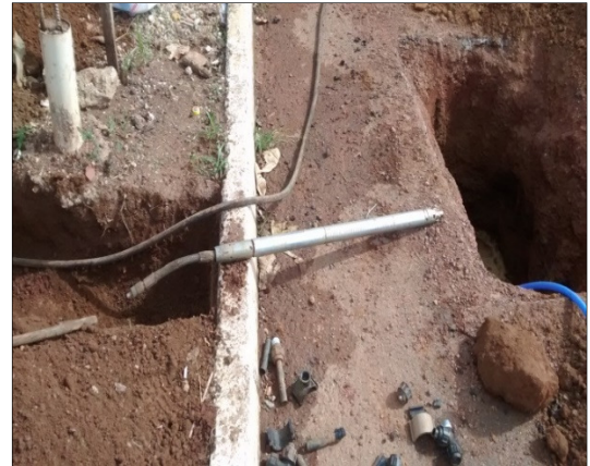
Figura 9 - Haste pneumática da perfuratriz. Fonte: Do autor (2015)
