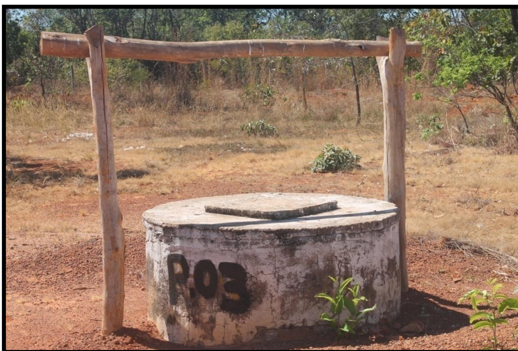
Figura 18 - Poço de monitoramento situado na jusante do Aterro Sanitário.
