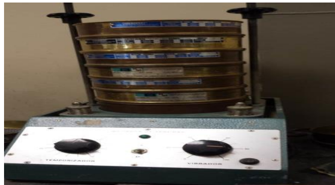
Figura 7 – Ensaio de Determinação da Granulometria Fonte: Autor, 2015
