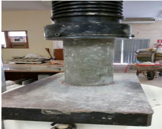
Figura 12 - Corpo de prova colocado para realização do ensaio de (Resistência a compressão aos 28 dias) Fonte: Autor, 2015.
