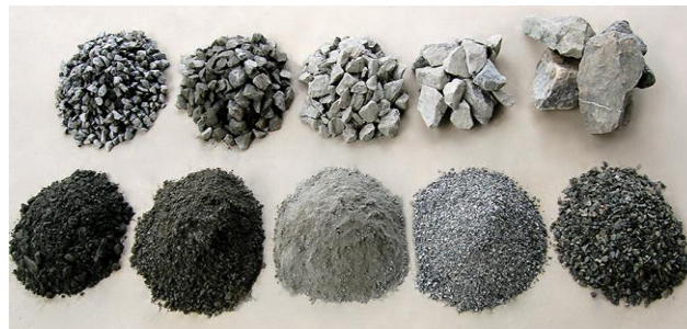
Figura 4 - Britas de dimensões variadas. Fonte: Sucess Engenharia
