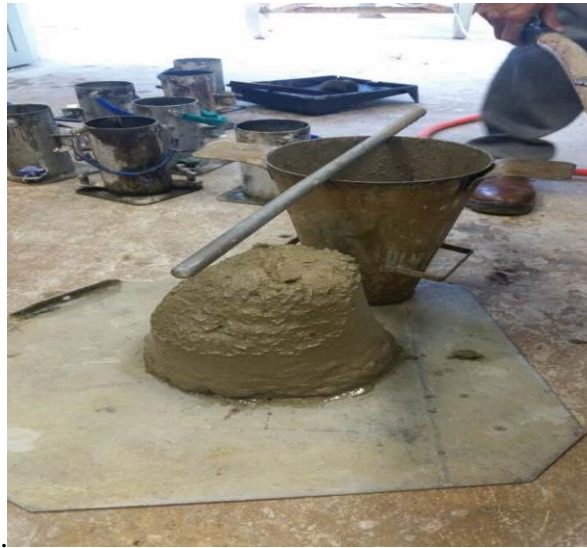
Figura 10 - Determinação de consistência pelo abatimento do tronco de cone da mistura inicial. Fonte: Autor, 2015.
