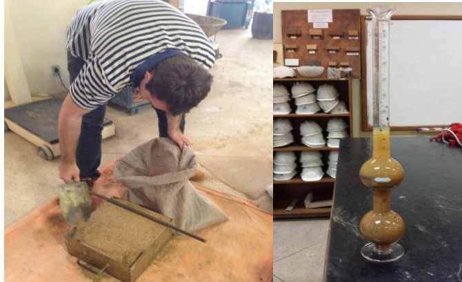
Figura 6: Determinação da massa unitária do agregado miúdo Fonte: Autor,2015.
