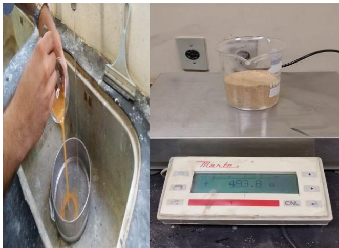
Figura 8 - Ensaio de Determinação de Material Pulverulento da Areia Natural Fonte: Autor, 2015
