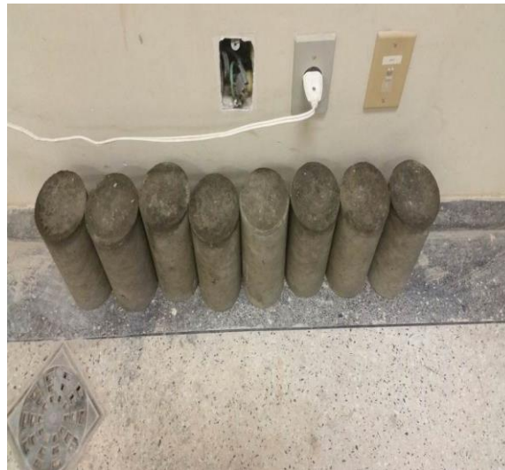
Figura 11 - Corpos de provas após desmoldados, prontos para serem levados para cura úmida. Fonte: Autor, 2015.
