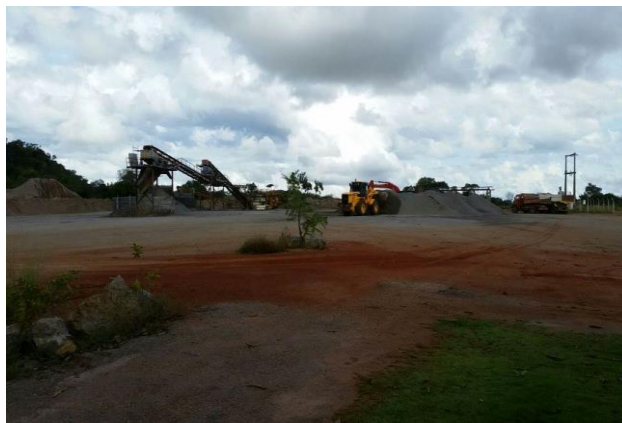
Figura 5 - Britador que produz areia artificial a esquerda Fonte: Autor, 2015.
