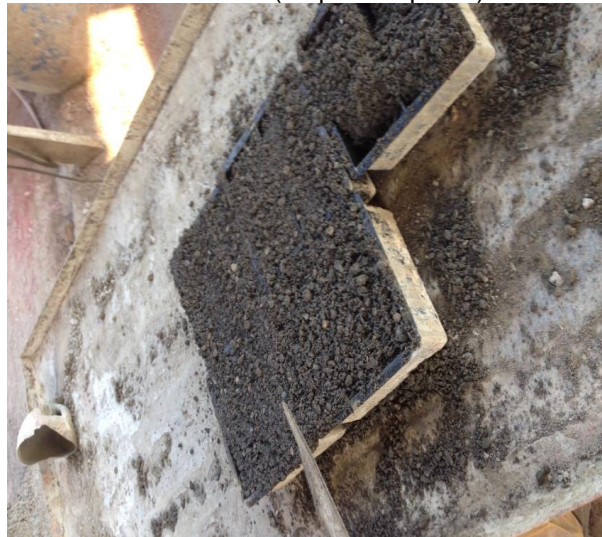
Figura 13: Blocos de concreto (corpos-de-prova) sendo enformados
