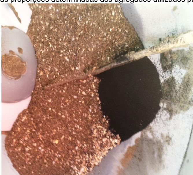
Figura 12: Mistura das proporções determinadas dos agregados utilizados para produzir os blocos
