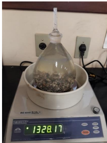
Figura 13: Processo para determinação da massa específica do agregado graúdo
