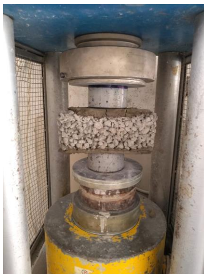
Figura 22: Ensaio de resistência à compressão axial em peças retangulares
