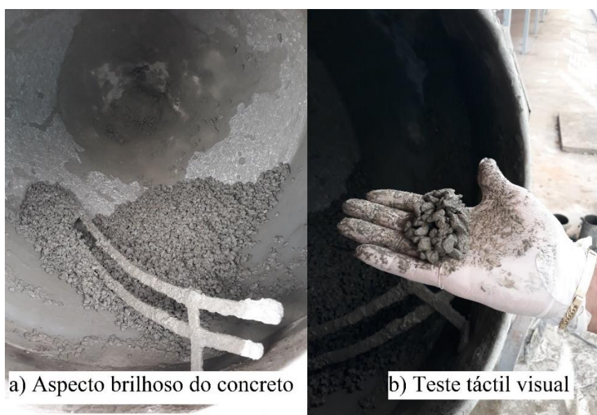
Figura 17: Aspecto brilhoso do concreto e análise tátil visual
