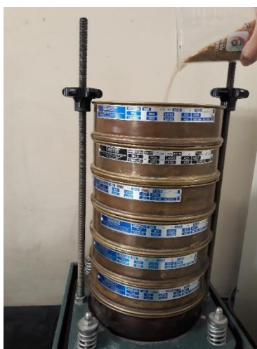
Figura 14: Processo de peneiramento do agregado miúdo
