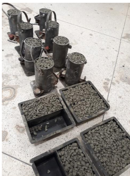
Figura 19: Moldagem do concreto permeável
