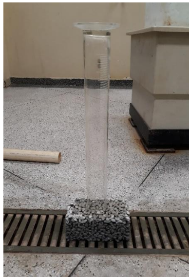
Figura 25: Ensaio executado para determinação do coeficiente de permeabilidade
