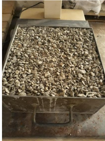
Figura 12: Determinação da massa unitária do agregado graúdo
