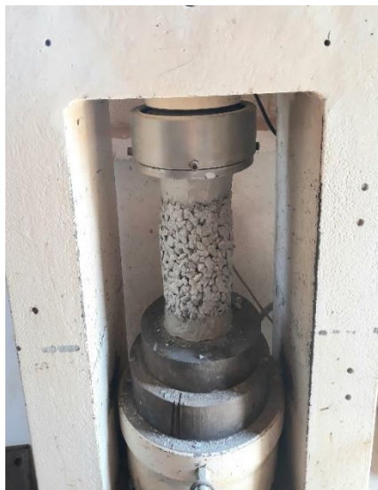
Figura 21: Ensaio de resistência à compressão axial em CP cilíndrico
