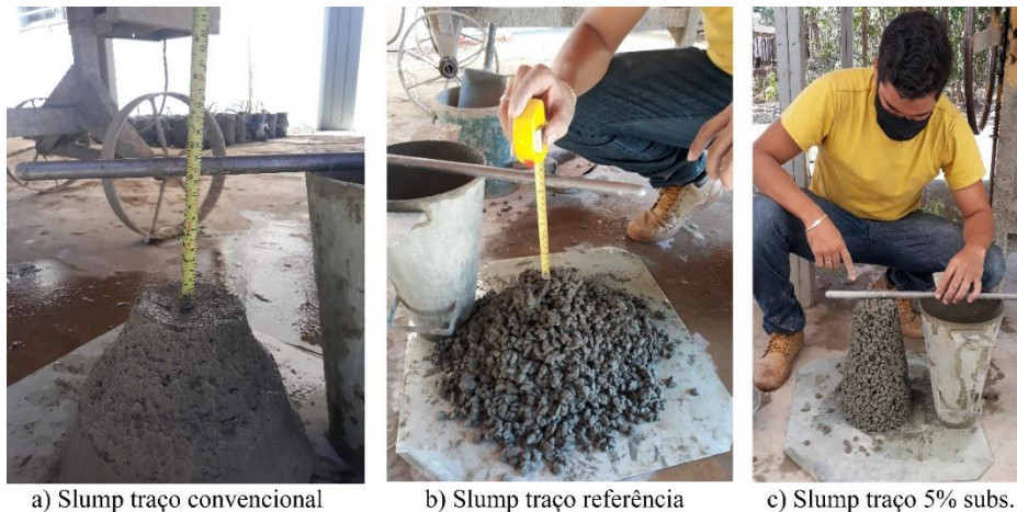
Figura 26: Execução do ensaio de abatimento para os três tipos de traço em estudo
