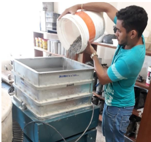
Figura 11: Processo de peneiramento do agregado graúdo
