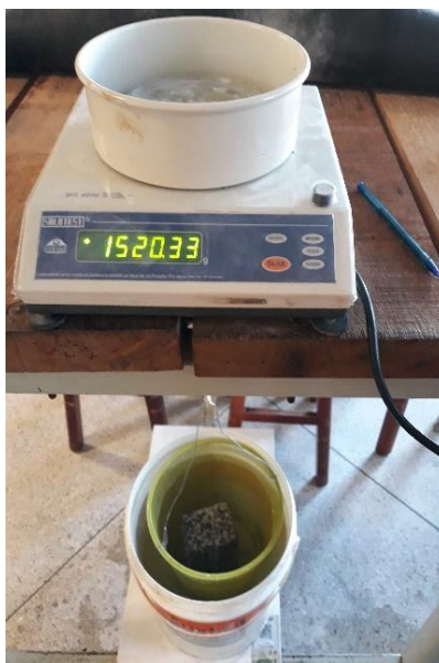
Figura 23: Aparelhagem para medição do peso seco e do peso submerso.
