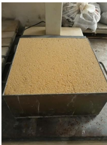
Figura 15: Determinação da massa unitária do agregado miúdo
