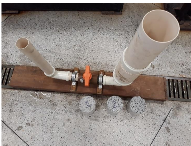
Figura 24: Permeâmetro de carga variável
