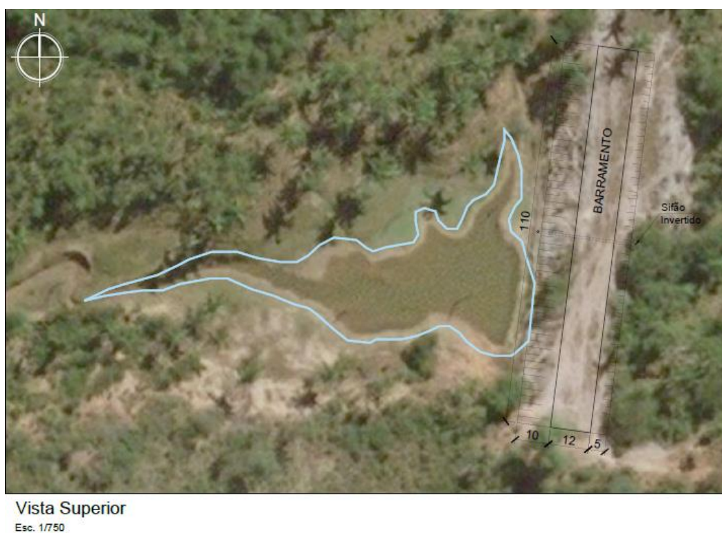
Figura 16 - Área do espelho d'água da barragem
