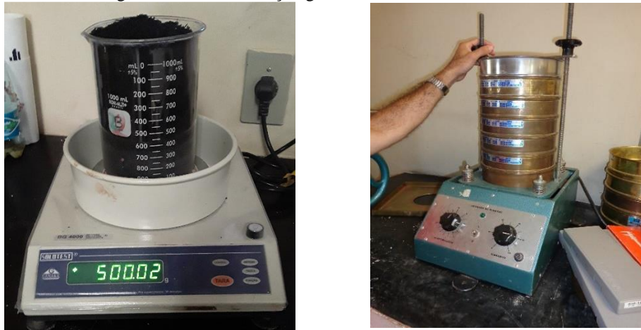
Figura 10 - Caracterização granulométrica do resíduo de borracha.
