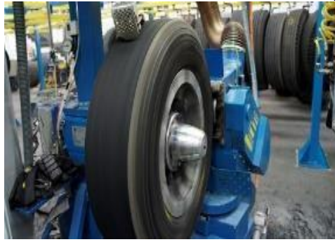
Figura 4: Retirada da borracha da banda de rolagem.
