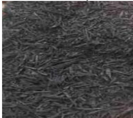
Figura 5: Borracha resultante do processo de raspagem
