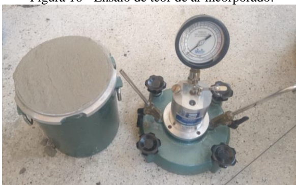
Figura 16 - Ensaio de teor de ar incorporado.
