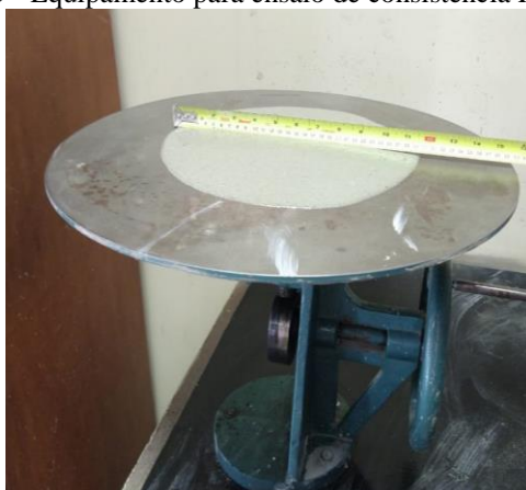
Figura 15 - Equipamento para ensaio de consistência Flow table.
