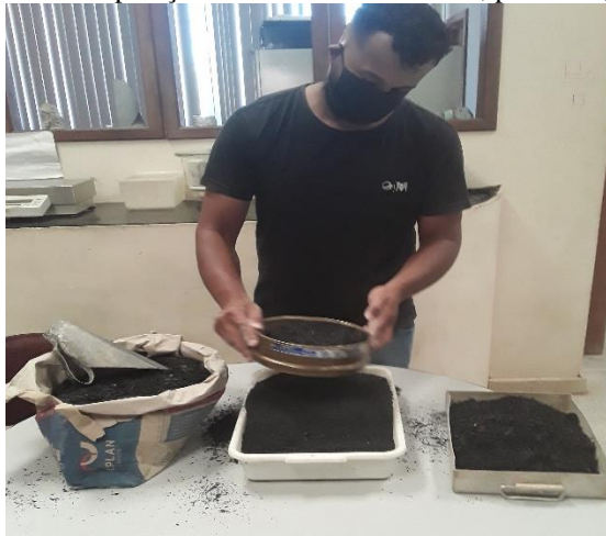
Figura 8 - Preparação do resíduo de borracha, peneira 4,8mm.
