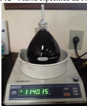
Figura 12 - Massa específica da borracha
