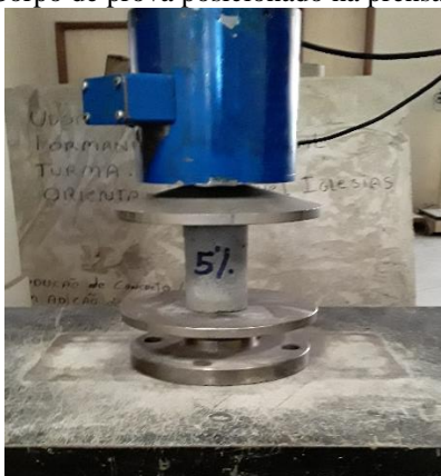
Figura 20 - Corpo de prova posicionado na prensa para ruptura.
