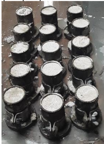
Figura 18 - Corpos de prova para ensaio de resistência a compressão.
