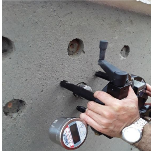
Figura 23 - Ensaio de resistência à aderência a tração.
