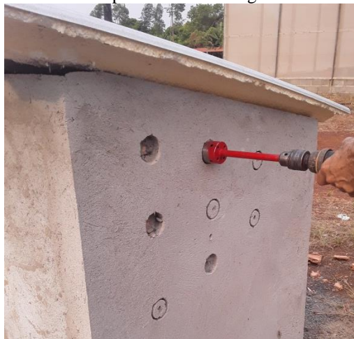
Figura 21 - Corte dos pontos de amostragem com a serra copo.
