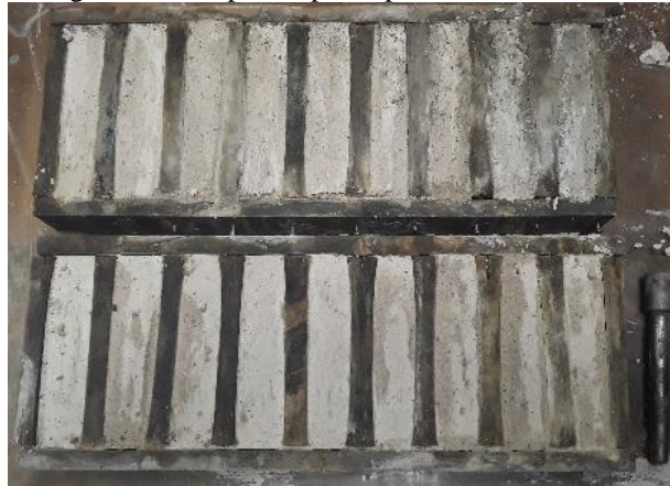
Figura 17 - Corpos de prova para ensaio de flexão.
