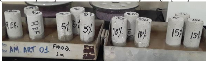
Figura 30 - Corpos de prova durante o ensaio de absorção de água por capilaridade.
