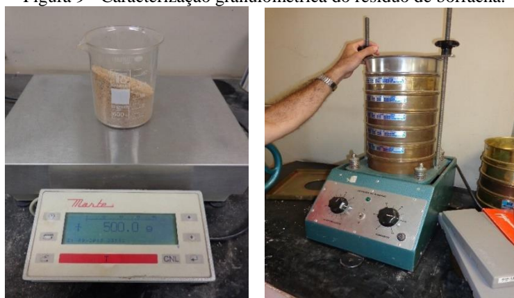
Figura 9 - Caracterização granulométrica do resíduo de borracha.
