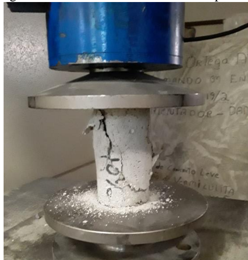
Figura 32 – Ensaio de resistência a compressão.
