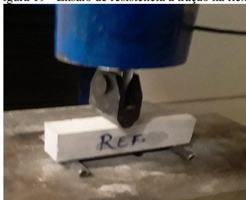
Figura 19 - Ensaio de resistência a tração na flexão
