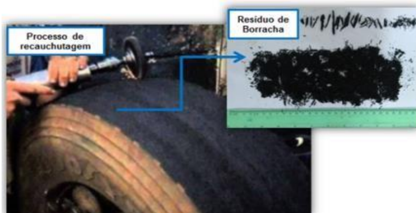
Figura 1 – Extração do resíduo de borracha de pneu.
