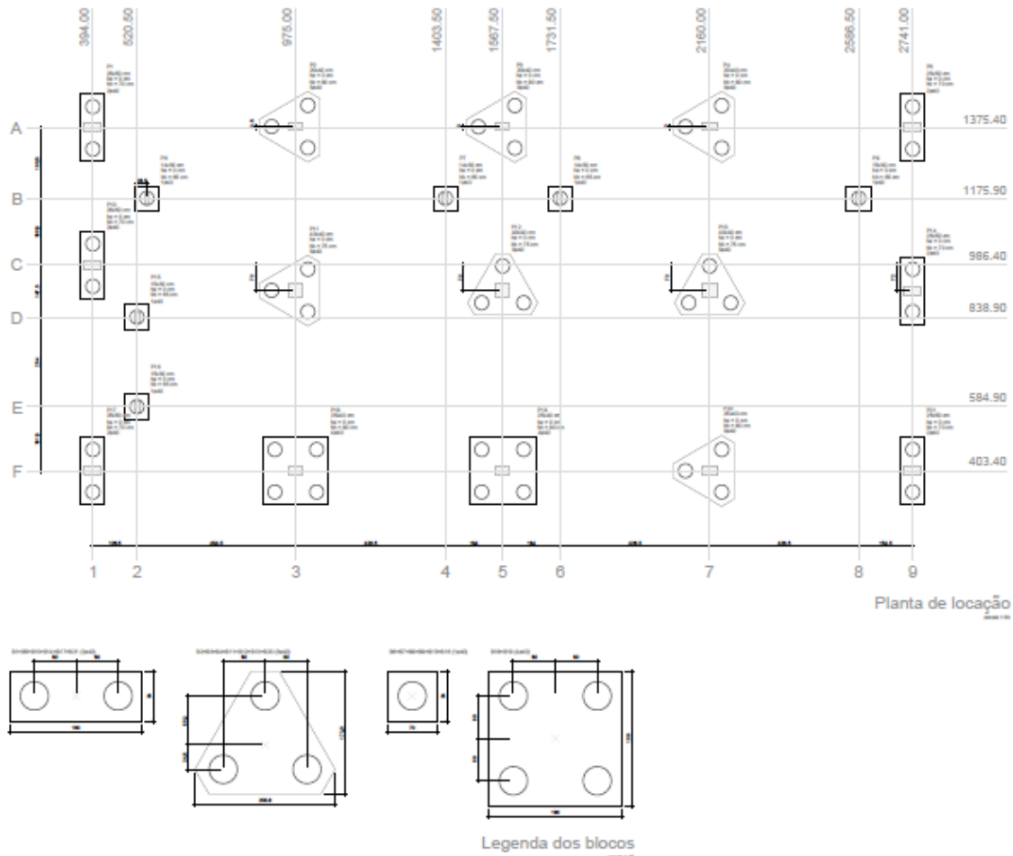
Figura 17: planta de localização dos blocos de coroamento
