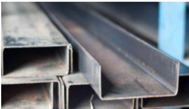
Figura 2 - Perfis U simples formados a frio (PFF).
