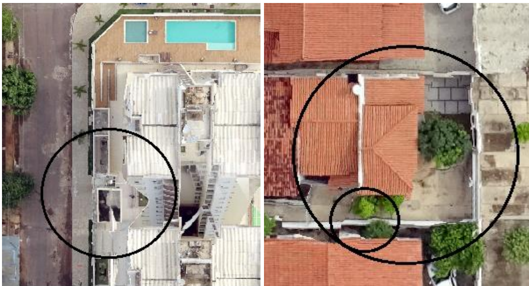
Figura 9 Distorções em vértices e arestas das edificações.
