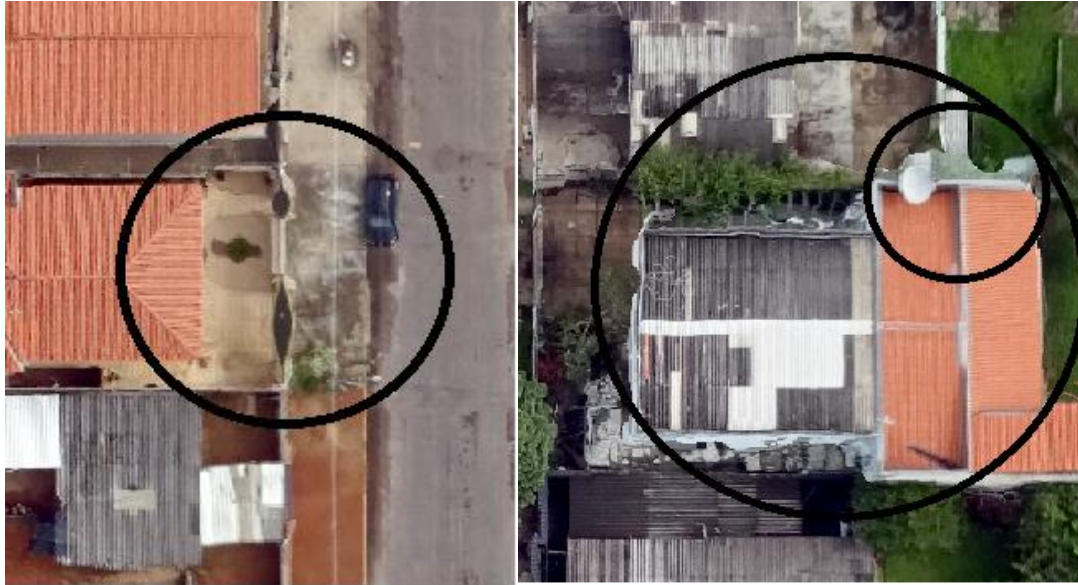
Figura 10 - Distorções em vértices e arestas das edificações.
