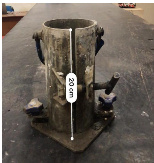
Figura 28 - Altura do molde para compressão
