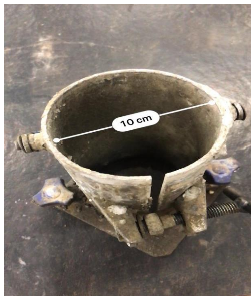
Figura 27 - Diâmetro do molde para compressão.
