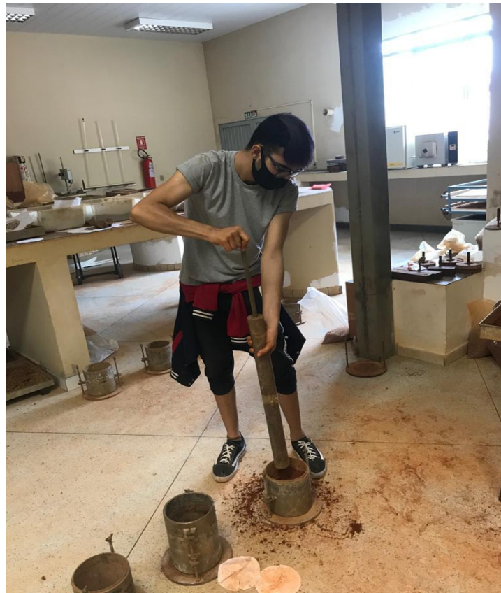
Figura 26 - Compactação da amostra.
