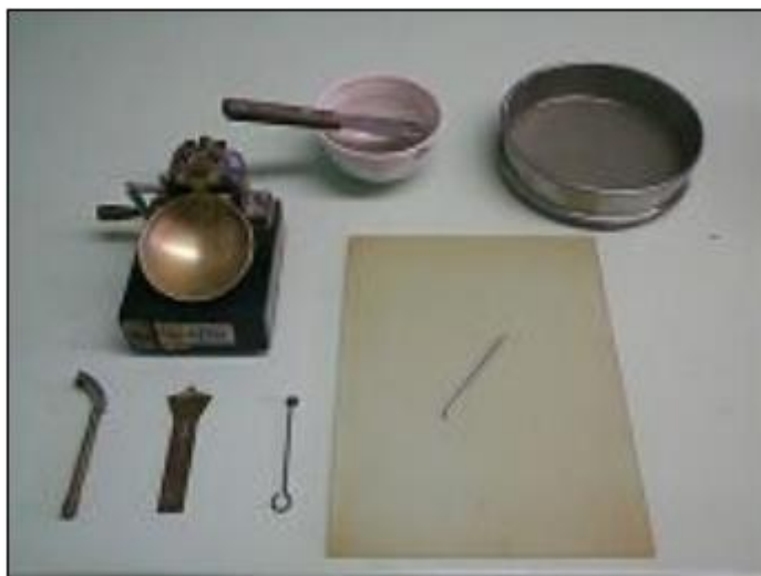
Figura 12 - Limite de Liquidez.
