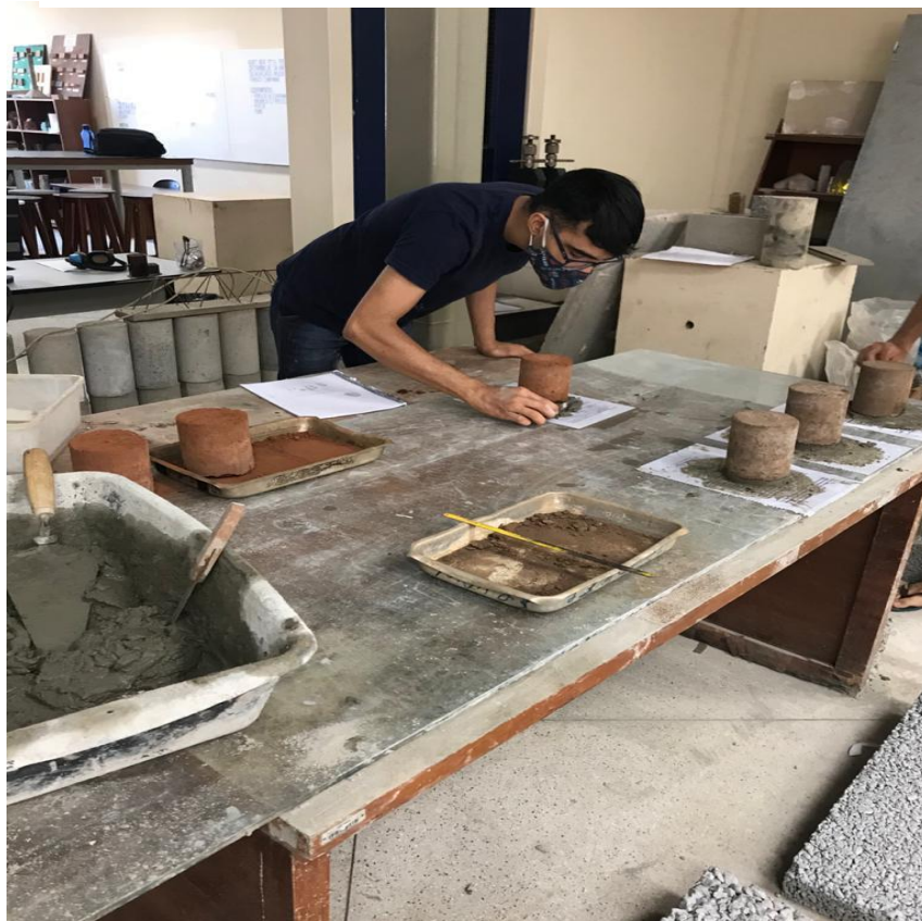
Figura 29 - Recapeando os corpos-de-prova.
