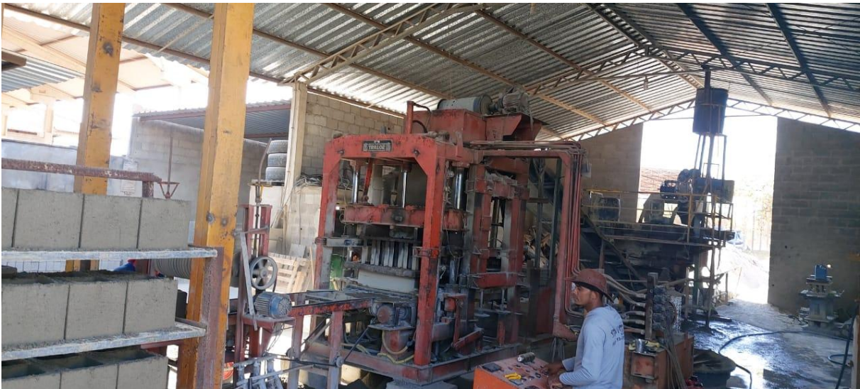
Figura 8 – Produção dos blocos de concreto na fábrica III.
