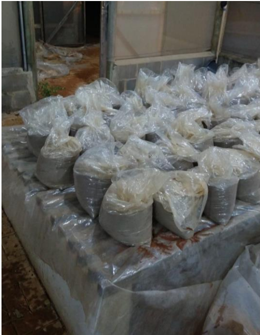
Figura 3: Acondicionamento do solo com calcário
