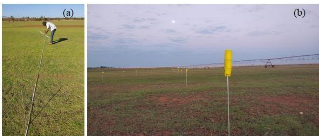
Figura 3: Medições e alinhamento entre coletores (a); Disposição de coletores na área em estudo (b).
