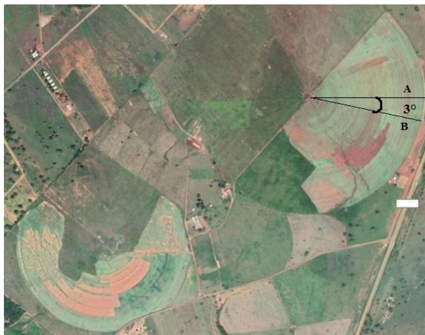
Figura 4: Disposição das linhas A e B de coletores em relação aos aspersores.
