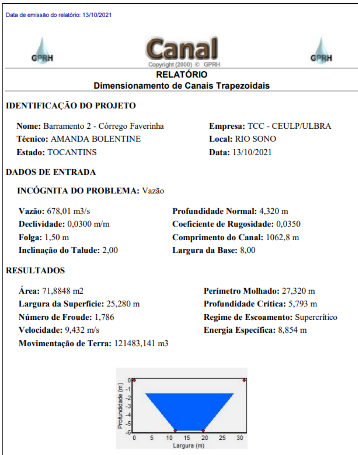
Figura 39: Resultados do dimensionamento do Canal do Barramento 2
