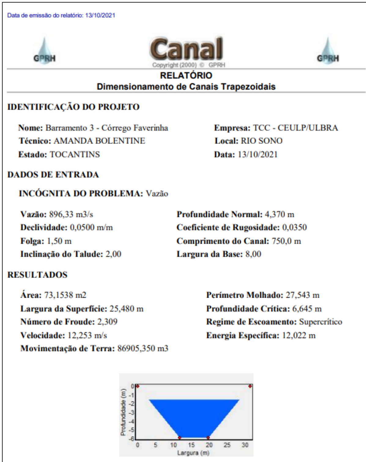
Figura 40: Resultados do dimensionamento do Canal do Barramento 3
