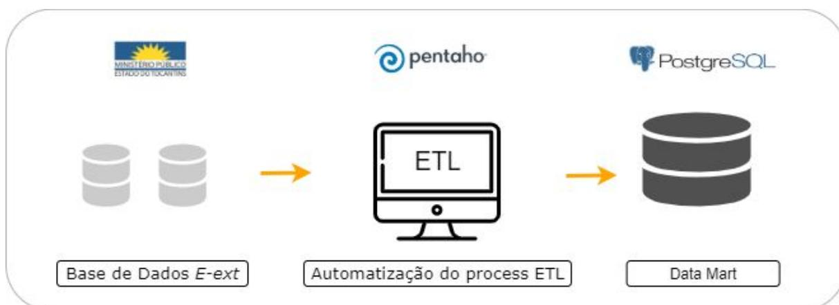
A relação entre as ferramentas, mostradas na Figura 8, corresponde a base de dados *E-ext*, que foram os dados processados no projeto, e utilizando a ferramenta *Pentaho Data Integration* esses dados foram extraídos das suas origens. O próprio PDI realizou o processo de extração, transformação e carga dos dados no *data mart* construído através da ferramenta *PostgreSQL*. Todos estes softwares utilizados serão detalhados nas próximas seções.
