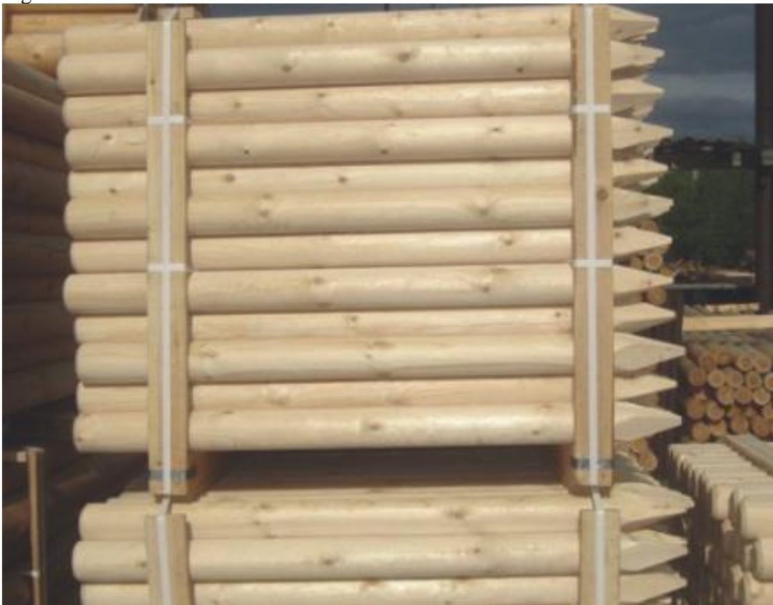
Figura 4: Estacas de Madeira
