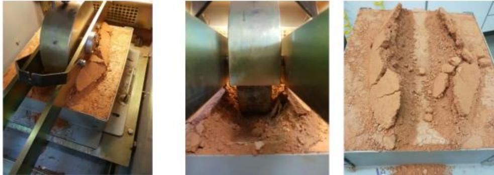
Figura 11: Pormenores do estado do solo tratado, após o ensaio de pista nº 1.
