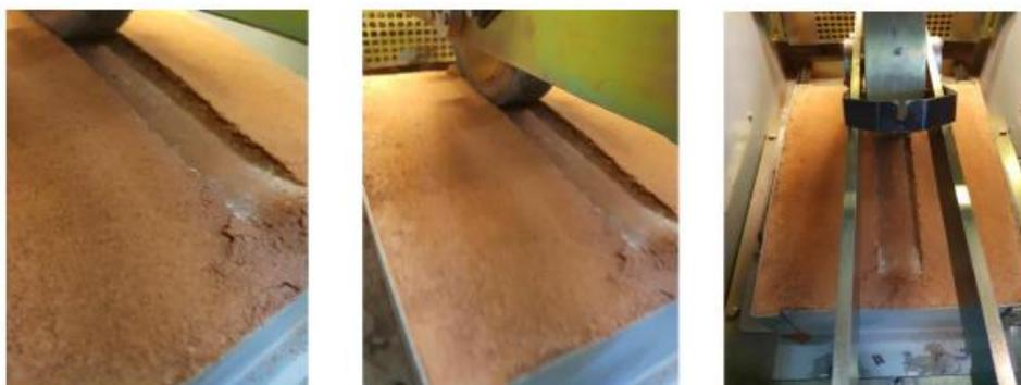
Figura 12: Pormenores do estado do solo tratado após o ensaio de pista com Ecolopavi
