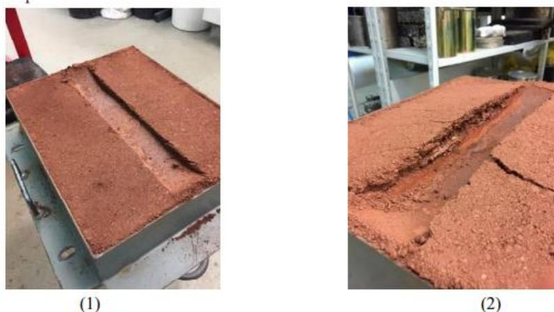
Figura 9: Pormenor do solo reforçado com geotêxtil sobre a 1ª camada (1) e sobre a 3ª camada (2).
