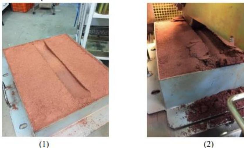
Figura 7: Pormenor do solo reforçado com a geogrelha sobre a 2ª camada (1) e sobre a 3ª camada (2)
