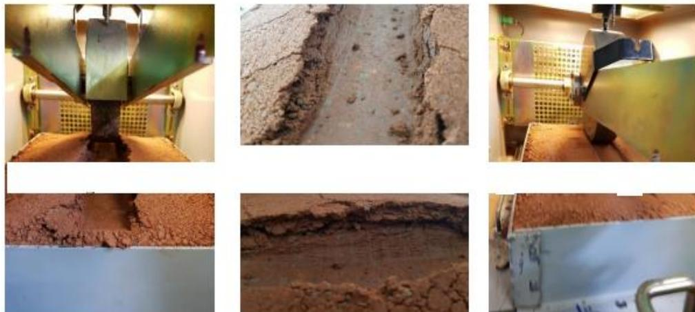
Figura 10: Pormenores do estado do solo não tratado após o ensaio de pista
