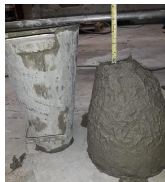
Figura 2 – Ensaio de Slump test traço25mm.
