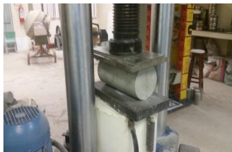
Figura 28: Ensaio de Tração por compressão diametral
