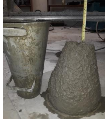
Figura 4: Ensaio de Slump test traço50mm.
