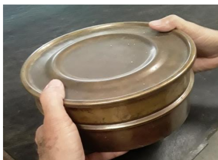
Figura 22: Determinação da finura por meio da peneira 75 \mu\text{m} .
