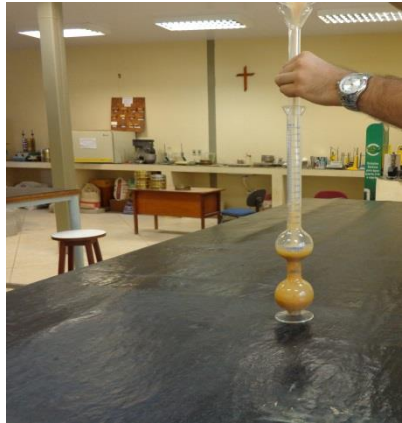
Figura 16: Determinação da massa específica do agregado miúdo.
