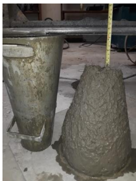
Figura 23: Determinação da consistência pelo abatimento do tronco de cone (Slump test).
