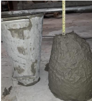
Figura 3: Ensaio de Slump test traço35mm.
