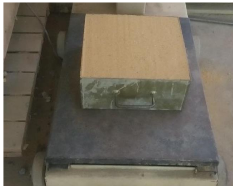
Figura 17: Determinação da massa unitária do agregado miúdo.
