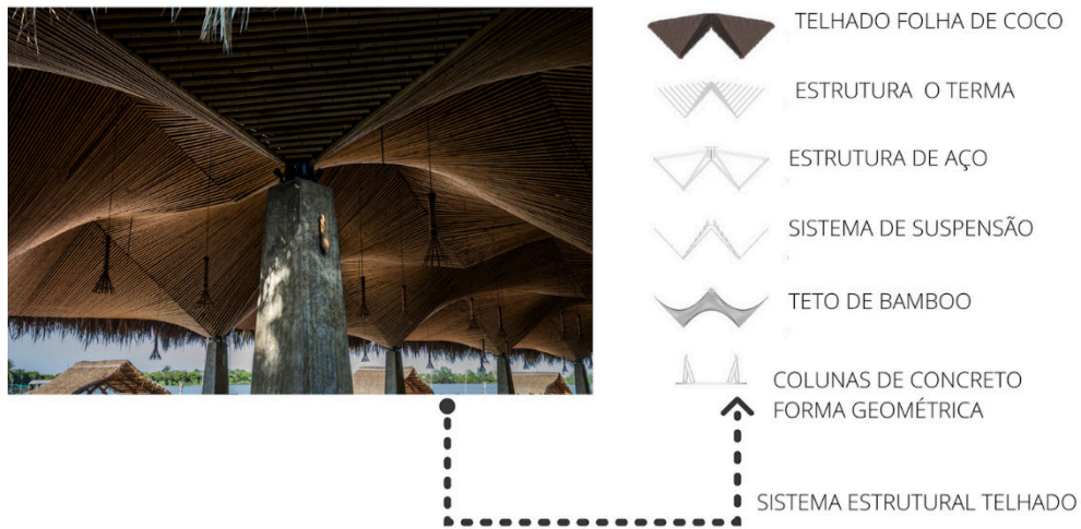
Figura 6-sistema construtivo cobertura com uso de materiais locais, , Que Du-Vietnã
