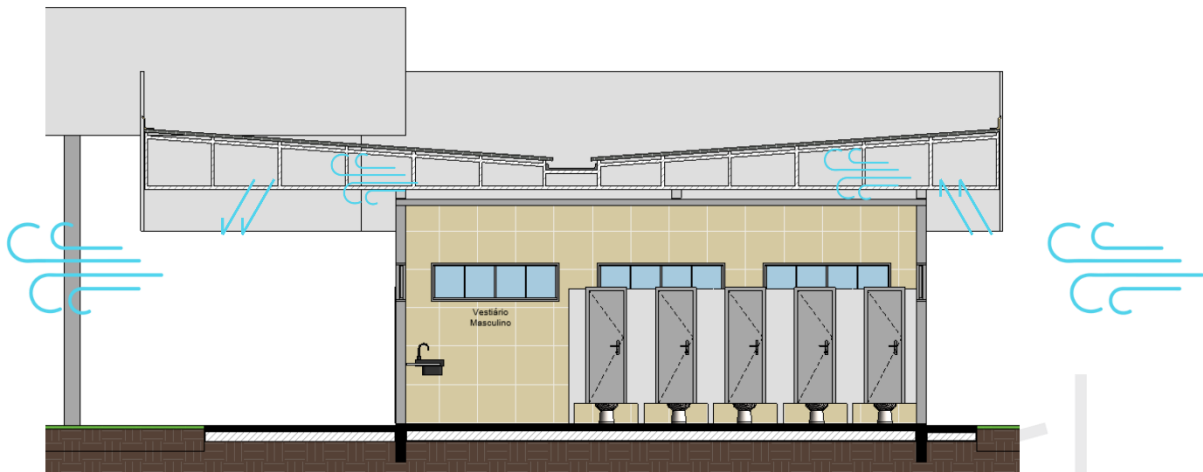
Figura 25: Corte Esquemático – Ventilação entre Laje e Telhado
