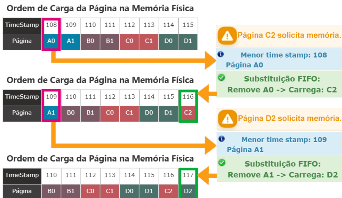
Figura 7 - Exemplo de funcionamento do algoritmo FCFS
