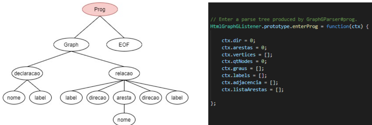
Figura 24: Função enterProg e sua posição na AST.
