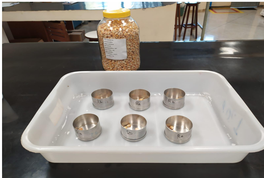
Figura 6 - Teste de Umidade
