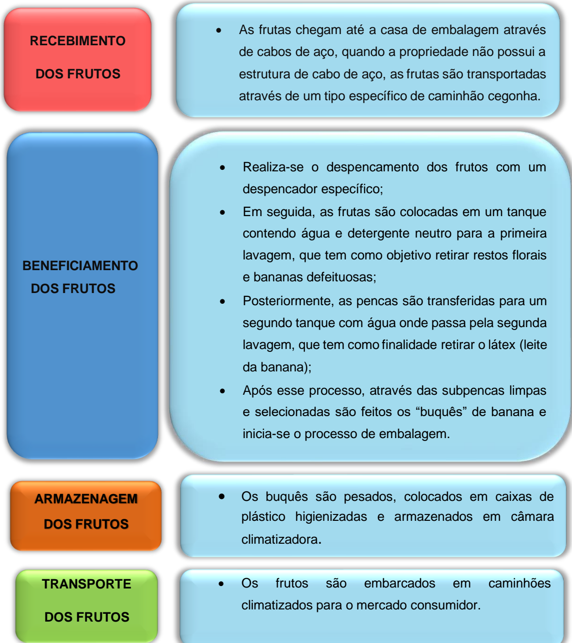
Figura 4. Esquema de beneficiamento de banana em uma Packing House.
