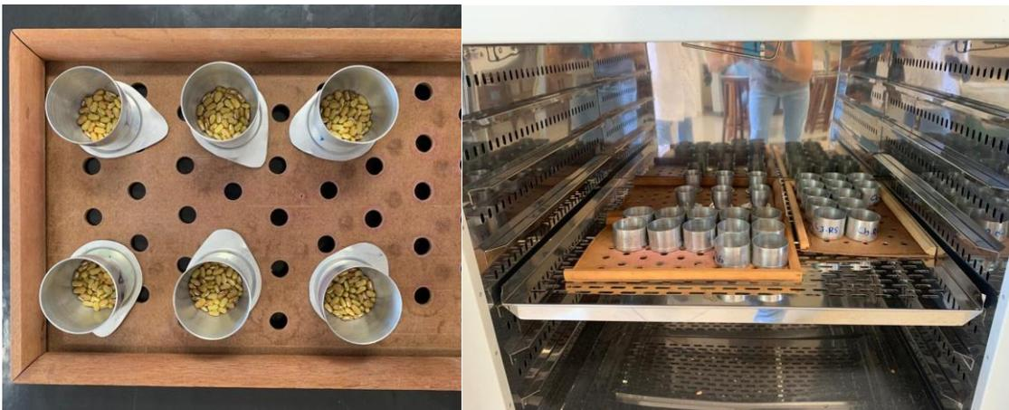
Figura 3. Determinação do grau de umidade em sementes de feijão-azuki.
