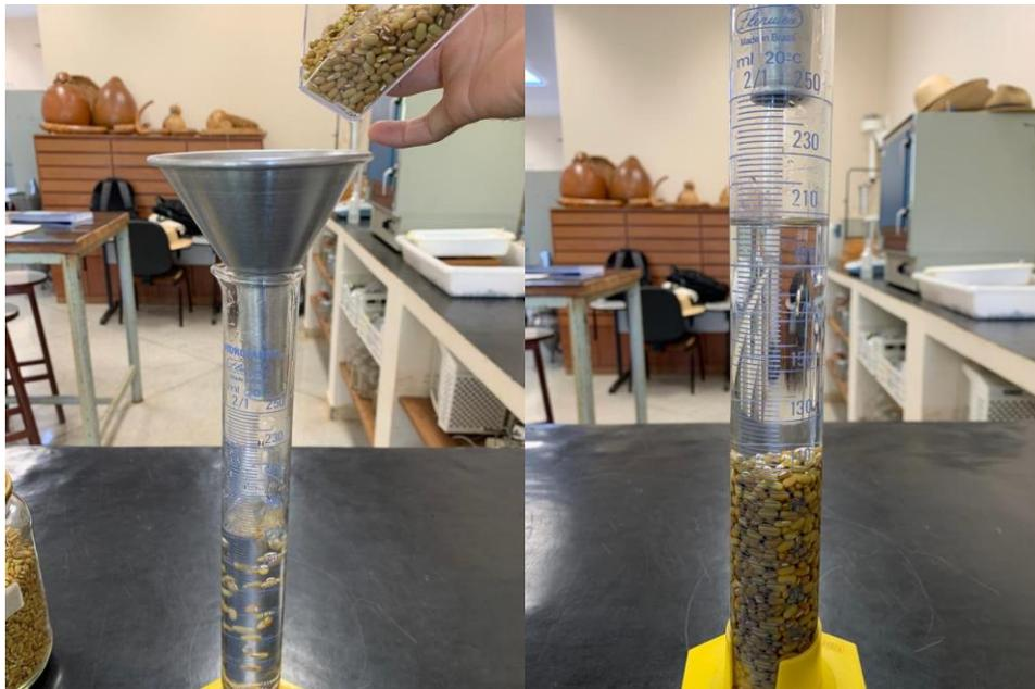
Figura 2. Determinação de peso real em sementes de feijão-azuki.
