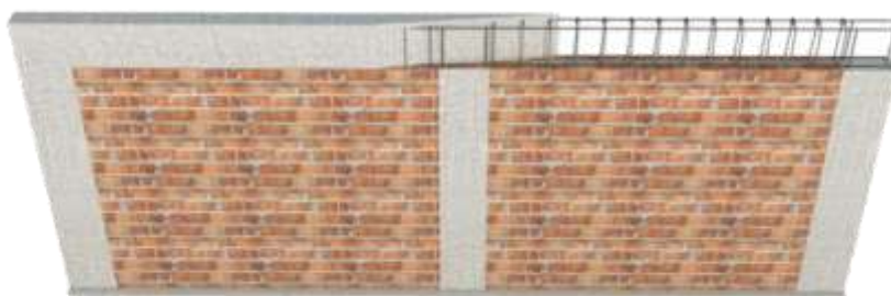
Figura 39: Viga em concreto armado
