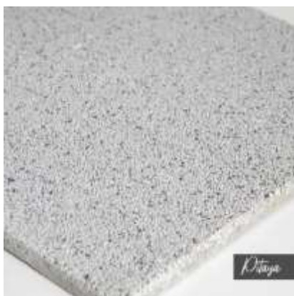
Figura 21: Revestimento Fulget cimentício
