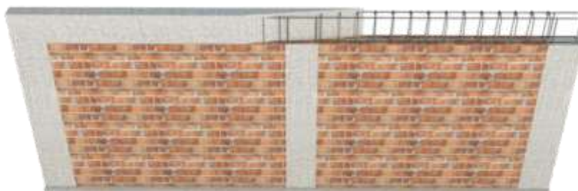
Figura 15: Viga em concreto armado
