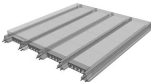
Figura 4 - Laje pré-moldada com EPS
