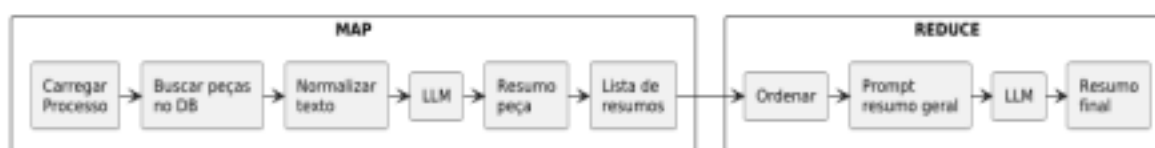
Figura 4 – Fluxo do pipeline Map-Reduce de sumarização.
